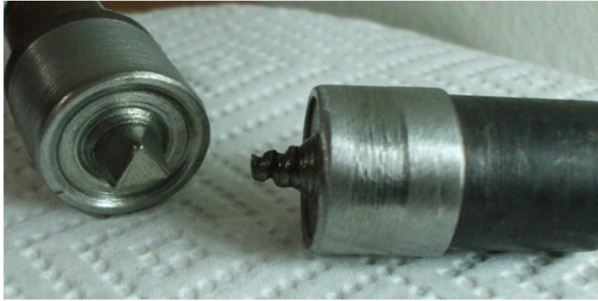
Şekil 6.2. Sürtünme karıştırma kaynağında kullanılan karıştırıcı uçlar.
