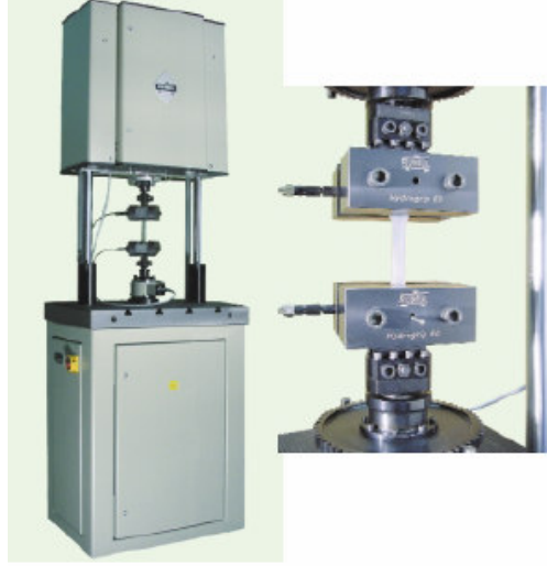
Şekil 6.8. Yorulma testlerinde kullanılan elektro-mekanik titreşimli rezonans tip yorulma test cihazı
