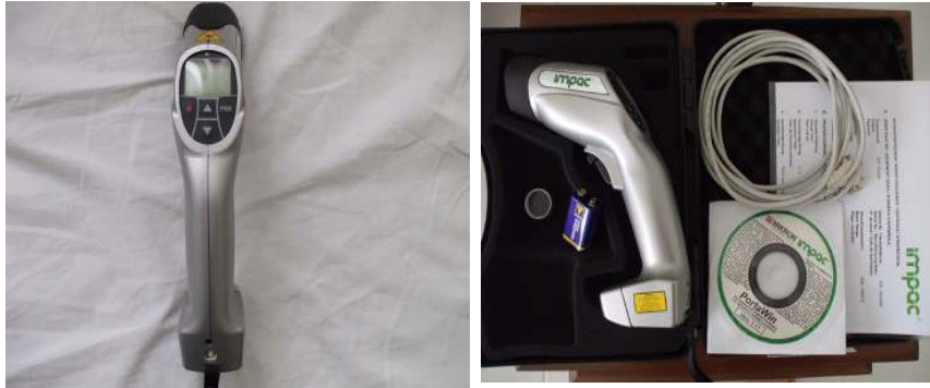
Şekil 6.9. Yüzey sıcaklık ölçümlerinin alındığı lazer pirometre
