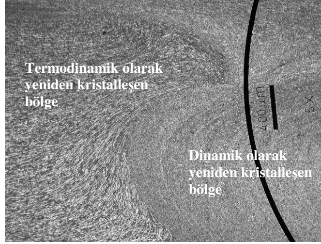
Şekil 7.6 Kaynak sonrası birleşme bölgesinde meydana gelen yapı ve formu
