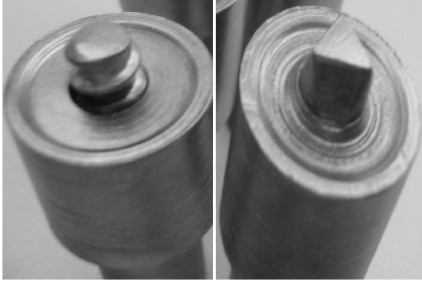
Şekil 6.1 Sürtünme karıştırma kaynağında kullanılan sürtünme elemanları
