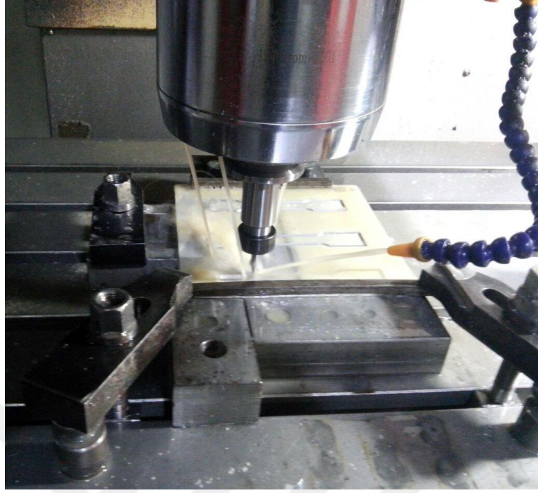
Şekil 5.2. Testerede plakalar halinde kesilen çekme deneyi numunelerin CNC de işlenmesi
