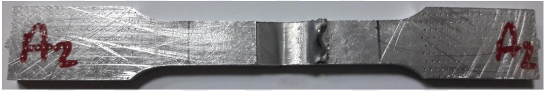
Şekil 7.8. 800/%2-2 Cu ,çekme deneyi sonrası kökten kopma
