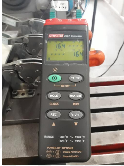
Şekil 5.7. SKK sırasındaki sıcaklıkların ölçümünde kullanılan sıcaklık veri kaydedici ve K-tipi termokupullar
