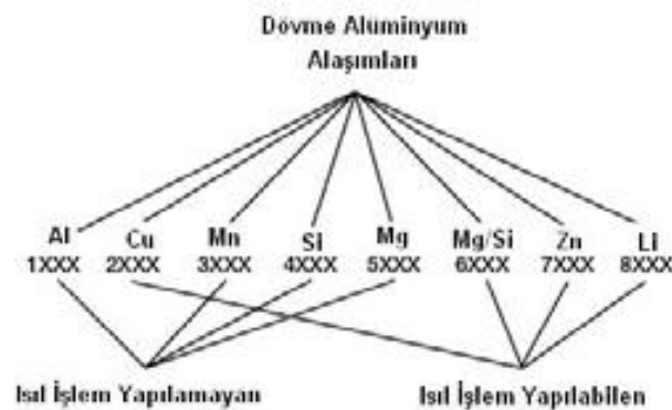
Şekil 2.1. Isıl işlem durumlarına göre dövme alaşımları [7]
