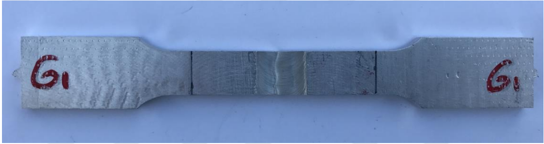
Şekil 7.7. 800/%4,5-2 Cu, çekme deneyi sonrası yüzey görüntüsü
