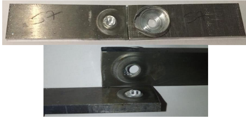
Şekil 6.110. Çekme testi sonrası kırılan S7 numunesi.
