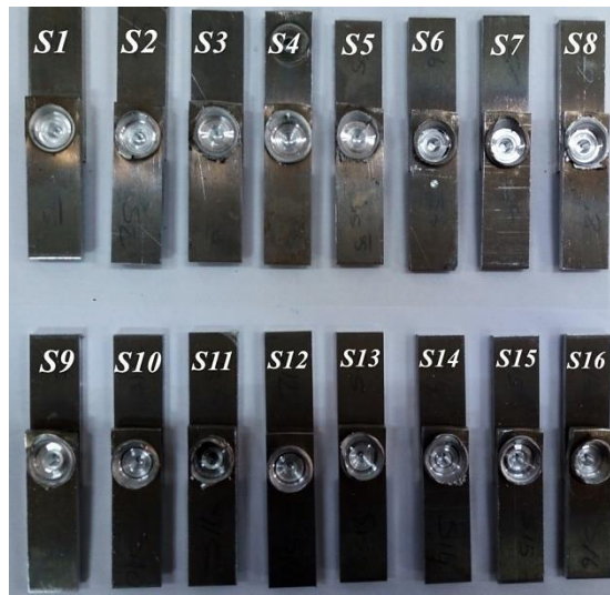
Şekil 5.5. Kaynak sonrası elde edilen numuneler.
