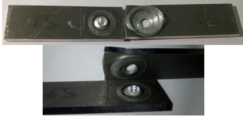
Şekil 6.112. Çekme testi sonrası kırılan S9 numunesi.
