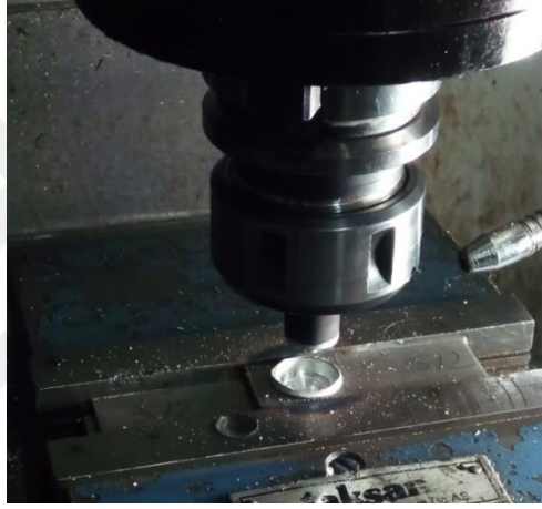
Şekil 5.4. SKNK geri çekilme işlemi.
