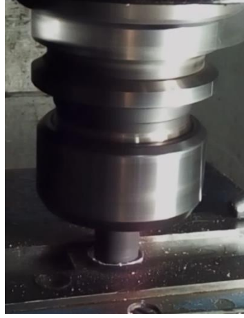
Şekil 5.3. SKNK daldırma ve karıştırma işlemi.
