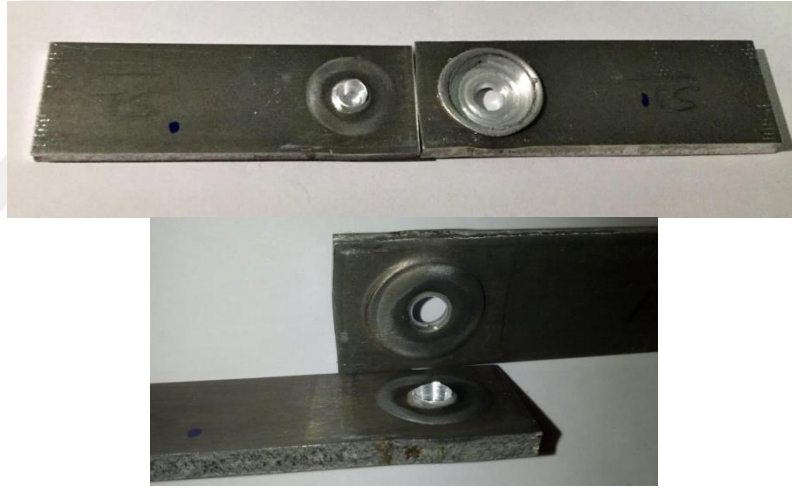
Şekil 6.102. Çekme testi sonrası kırılan S1 numunesi.
