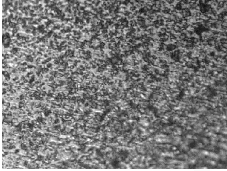
Şekil 4.4. SKP ile üretilen Al5083/%92Al 2 O 3 +%8h-BN kompozit tabakanın karıştırma bölgesinden elde edilen optik mikroskop görüntüsü.
