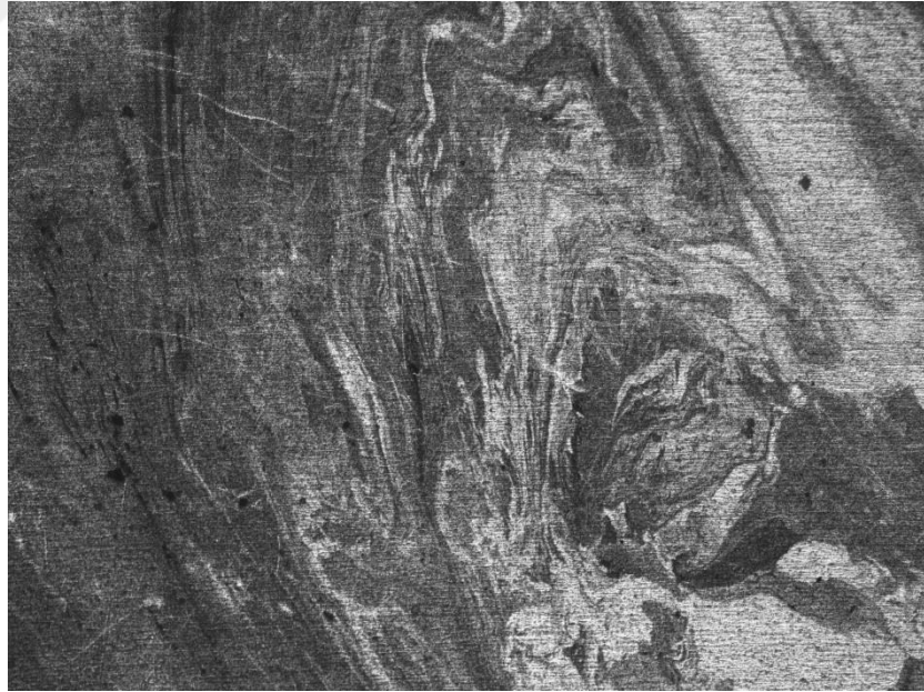
Şekil 4.1. SKP ile üretilen bir Al5083/ Al_2O_3+h-BN yüzey kompozitinin karıştırma bölgesinin optik mikroskop görüntüsü.
