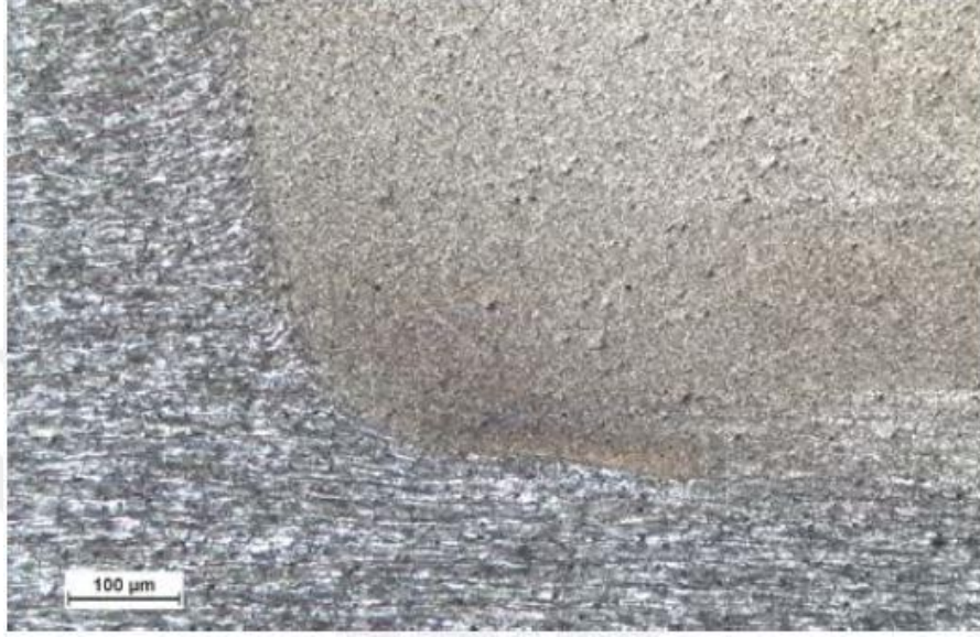
Şekil 2.5. TMAZ (solda) ve kaynak dikişi (sağda) sınırında karakteristik, ince taneli mikroyapı.
