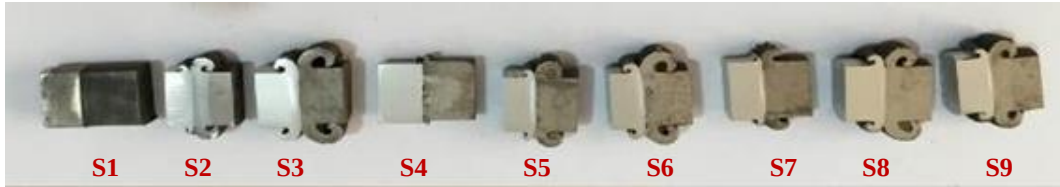
Şekil 4. 6. Mikroyapı ve sertlik ölçümü için hazırlanan numuneler.
