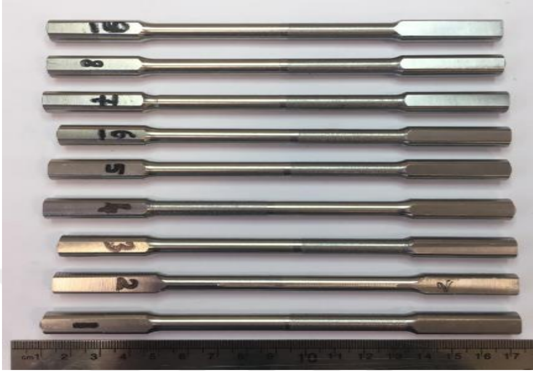
Şekil 4. 15. Burulma numunelerinin burulmadan önceki görüntüsü.
