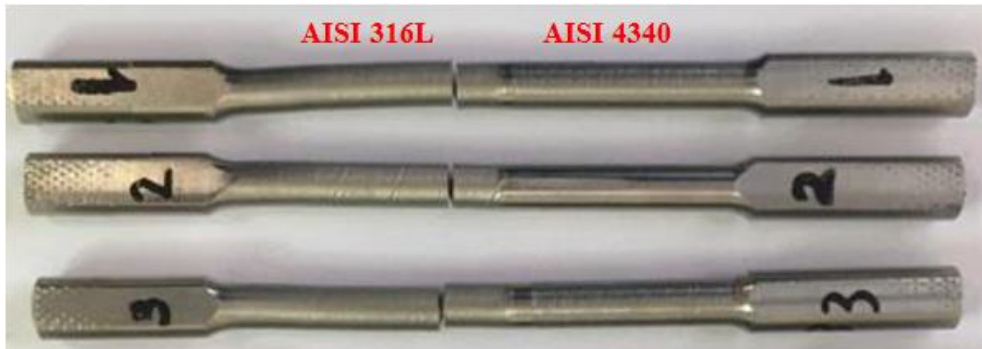
Şekil 5. 25. 2400 dev/dak'da kaynatılan numunelerin burulma sonucu resimleri.
