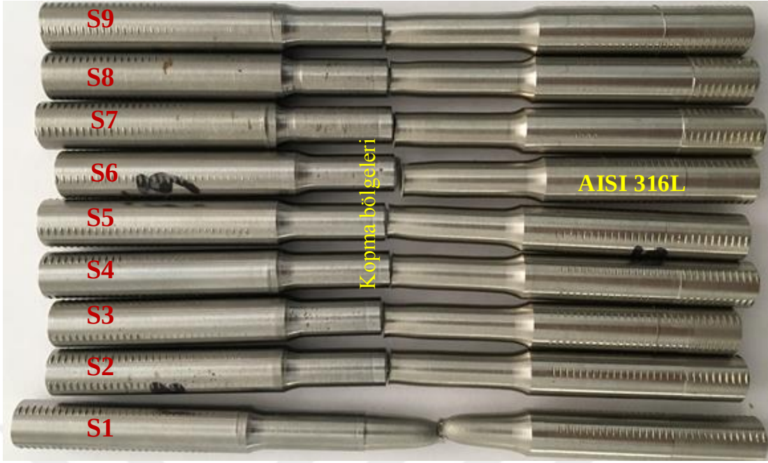
Şekil 5. 17. Çekme sonra kopma görüntüleri.
