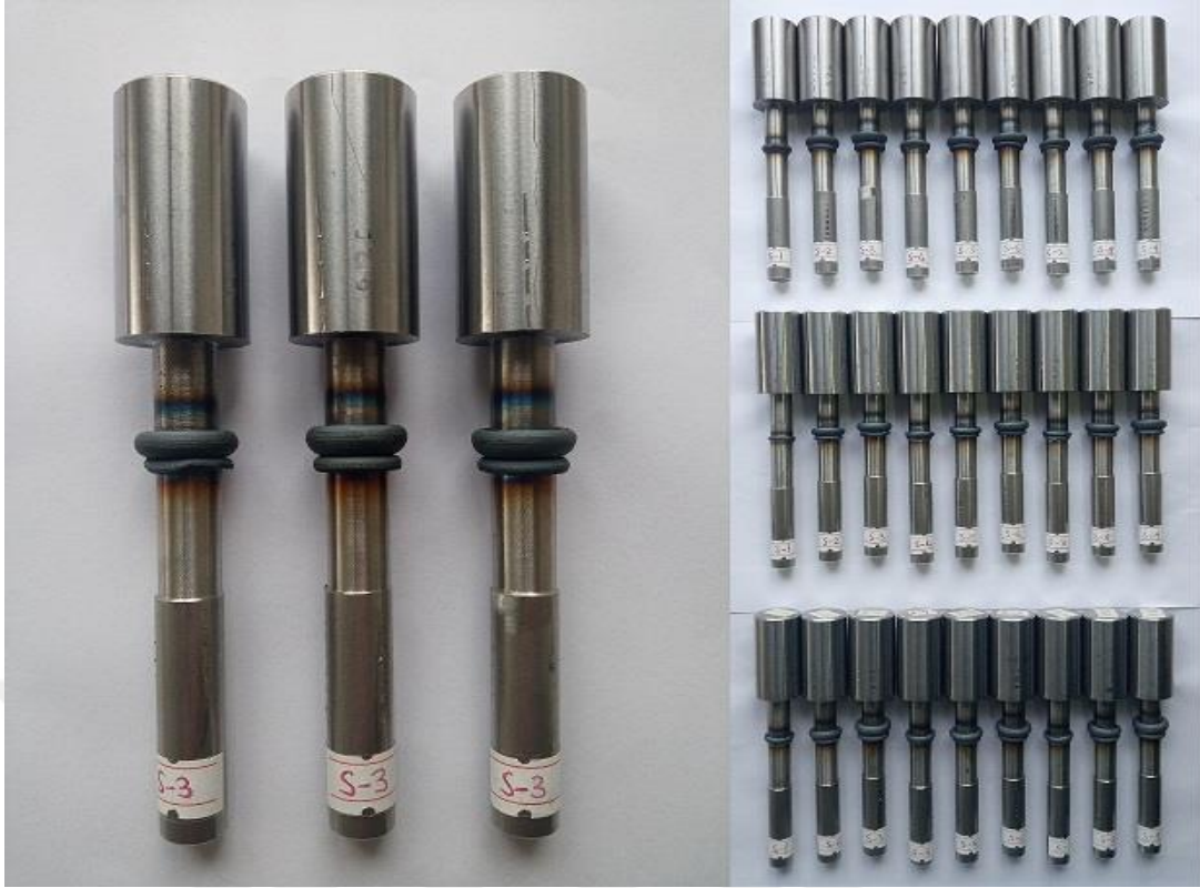
Şekil 4. 4. Kaynak sonrası numunelerin genel görünümü.
