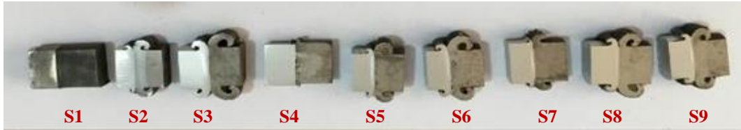
Şekil 4. 6. Mikroyapı ve sertlik ölçümü için hazırlanan numuneler.
