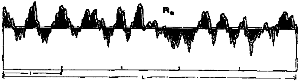
Şekil 2.9.1 R_a Parametresinin Şematik Gösterimi
