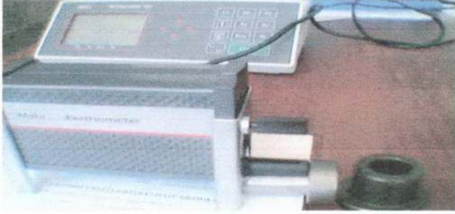
Şekil 3.7 Cihazla Numunelerin Yüzey Pürüzlerinin Tespiti
