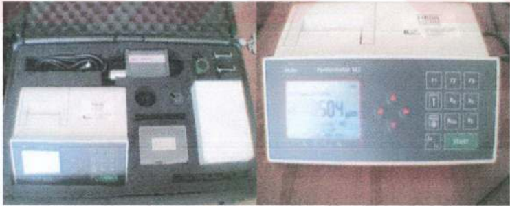
Şekil 3.6 Perthometer M2 V 3.03-00 Yüzey Pürüzlülüğü Ölçüm Cihazı
