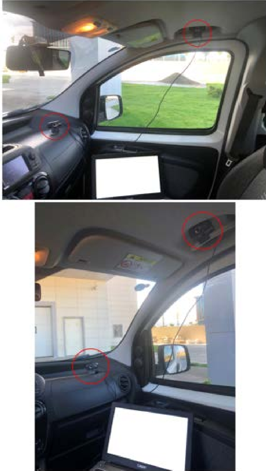
Şekil 3.5. Dikkat dağınıklığı tespiti için gerekli olan verilerin toplanması amacıyla kurulan kamera düzeneği.
