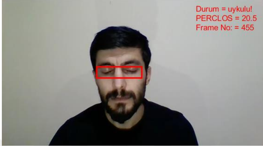
Şekil 4.5. Uygulamanın sürücü uykululuğunu tespiti, PERCLOS=%20.5
