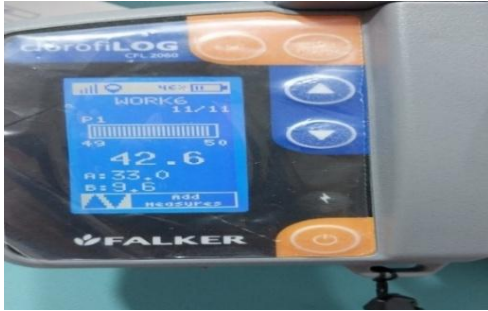
Resim 3.4. Klorofil ölçümlerinde yararlanılan SPAD cihazı
