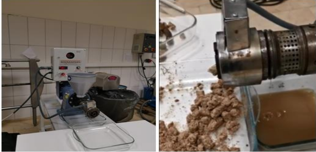
Şekil 3.1 Susam tohumundan presle yağın ayrılması
