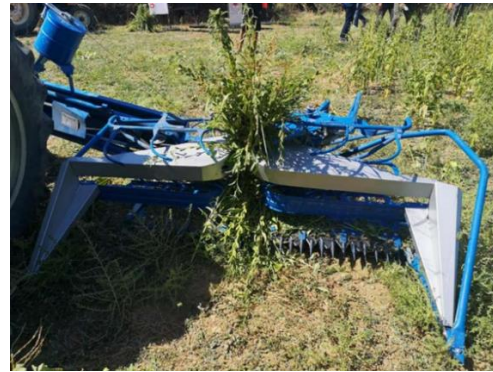
Şekil 1.2. Biçerbağlar ile Yarı Mekanize Hasatta Söküm ve Demetleme
