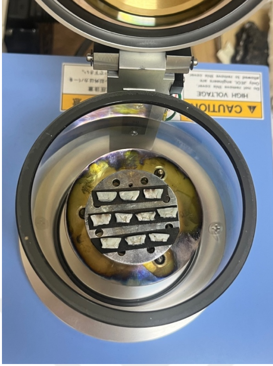
Şekil 3.11. %80 altın ve %20 paladyum kaplanmış dentin örnekleri
