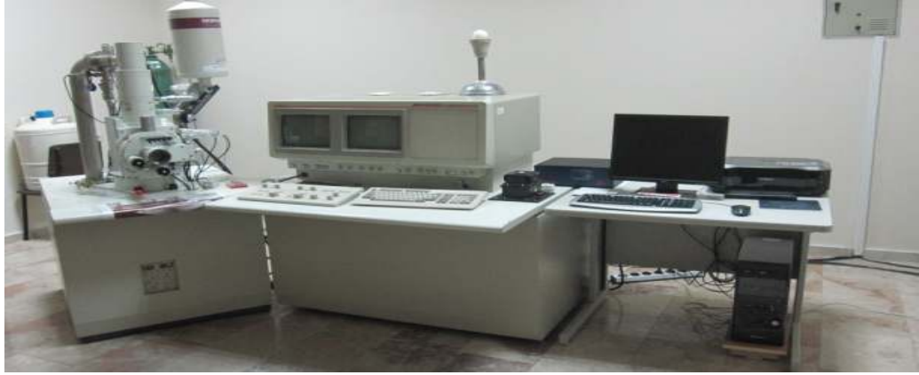
Resim 17. SEM analizinde kullanılan cihazın görünümü (JEOL JSM-5200, Tokyo, Japonya)
