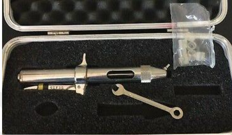
Şekil 2. 11: Madajet jet enjeksiyon sistemi
