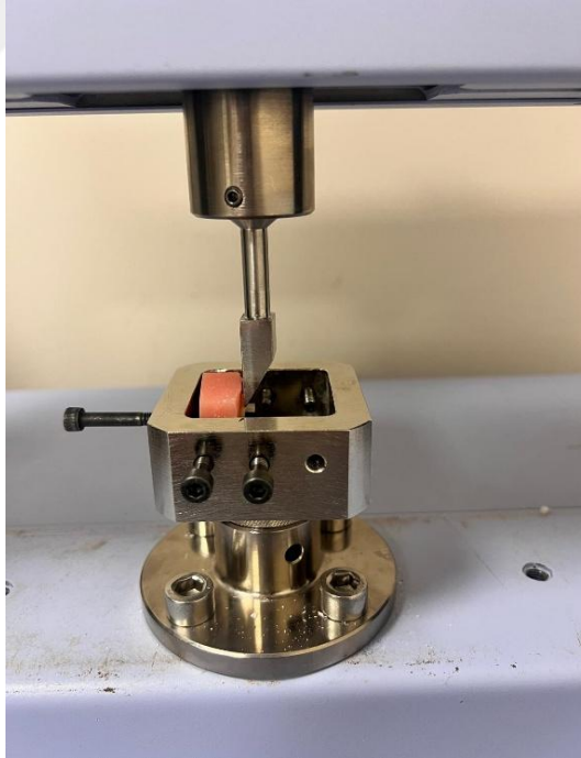
Şekil 3-22. Örneklerin test cihazına konumlandırılması
