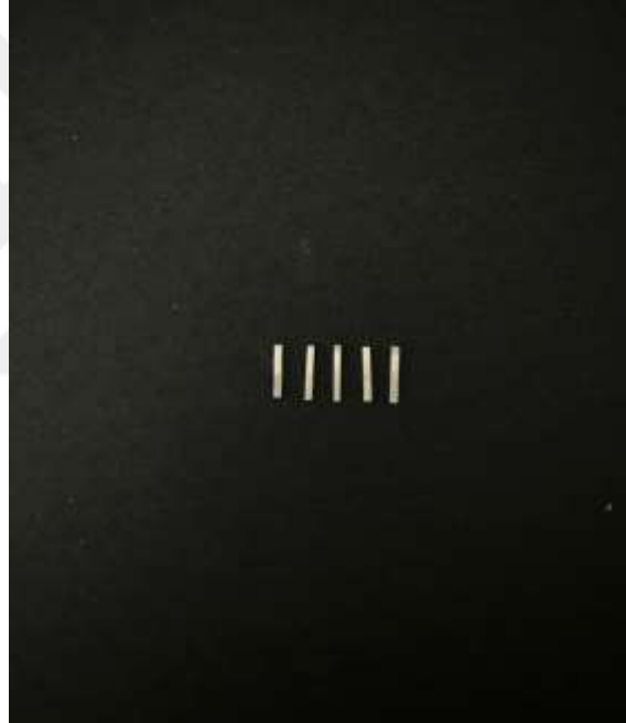
Şekil 3.46: Mikrogerilim Testi İçin Hazırlanan Diş Örneklerinden Elde Edilen Yaklaşık 1 mm 2 Boyutlarındaki Çubuk (Stick) Kesitler.
