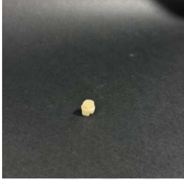
Şekil 3.44: Mikrogerilim Testi İçin Teflon Kalıp Kullanılarak Restoratif Materyal Uygulanmış Diş Örneği.
