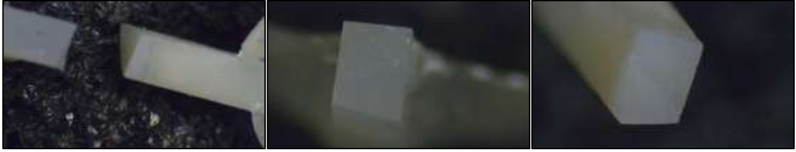
Şekil 4.22 Koheziv Kırık Gözlenen Filtek One Bulk Fill Grubuna Ait Örnek.
