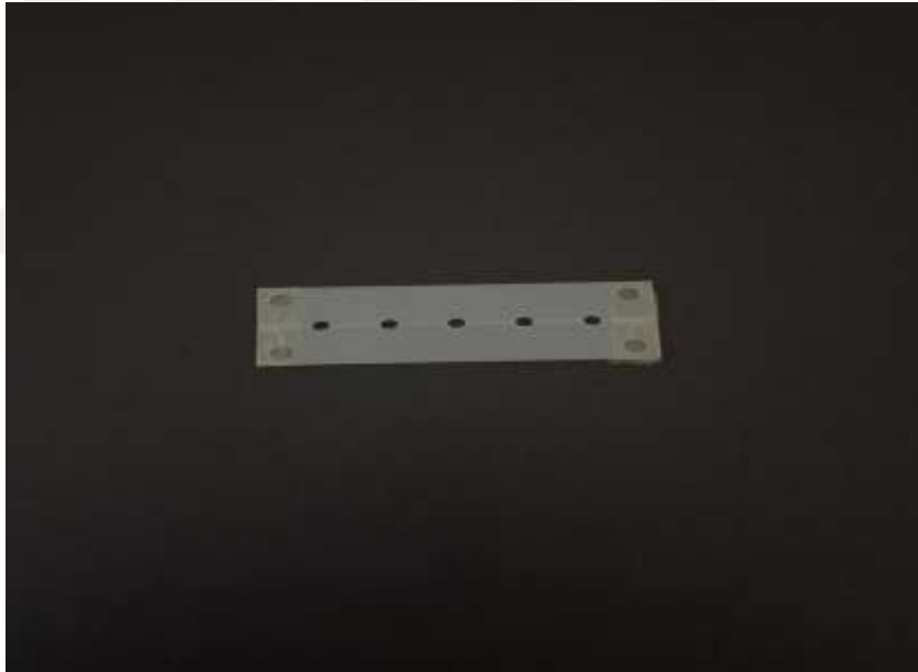
Şekil 3.18: Mikrosertlik Ölçümleri İçin Kullanılan Restoratif Materyallerin Yerleştirildiği Disk Formundaki Teflon Kalıp.
