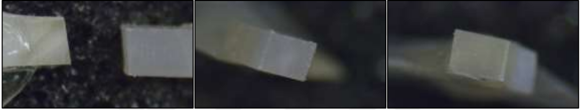
Şekil 4.21 Adeziv Kırık Gözlenen Filtek One Bulk Fill Grubuna Ait Örnek.
