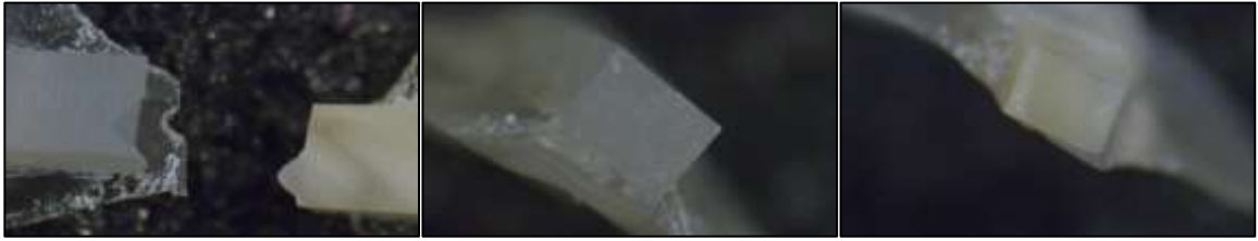
Şekil 4.23 Miks Kırık Gözlenen Filtek One Bulk Fill Grubuna Ait Örnek.
