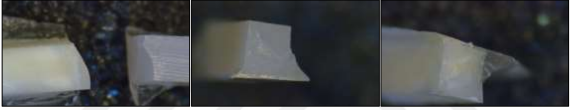
Şekil 4.26 Miks Kırık Gözlenen Dyract XP Kompomer Grubuna Ait Örnek.
