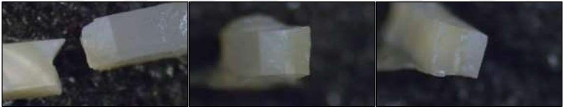
Şekil 4.18 Miks Kırık Gözlenen Neo Spectra Grubuna Ait Örnek.
