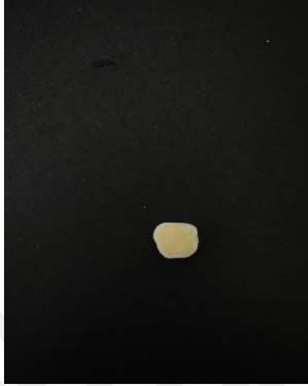
Şekil 3.40: Mikrogerilim Testi Öncesinde Yüzeyi Zımparalanarak Hazırlanmış Diş Örneği.
