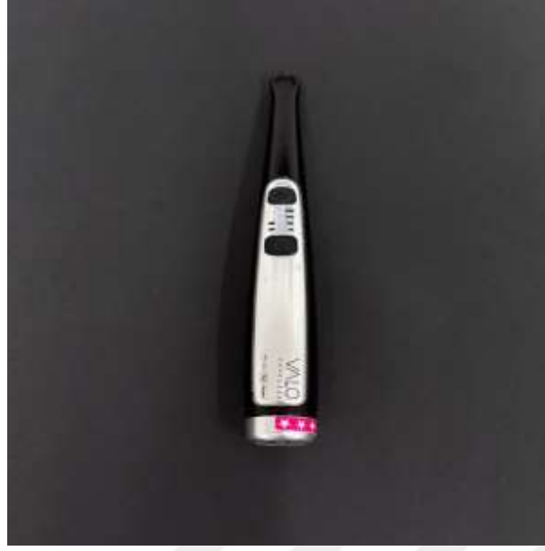
Şekil 3.7: Valo Grand LED Polimerizasyon Cihazı (Ultradent, South Jordan, UT, ABD).
