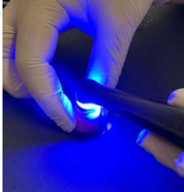
řekil 3.30: Mikrosızıntı Testi İin Restoratif İşlemi Tamamlanan Diřin Polimerizasyonu.
