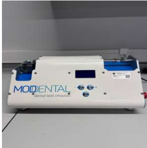
Şekil 3.13: MOD Dental Mikrogerilim Test Cihazı (Esetron, Ankara, Türkiye).
