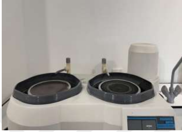
Şekil 3.12: Phoenix Beta Grinder /Polisher (Buehler, Almanya).
