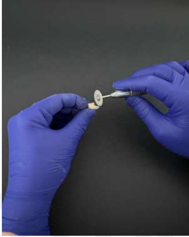
Şekil 3.39: Mikrogerilim Testi İçin Kök Kısımı Separatör ile Uzaklaştırılan Diş Örneği.
