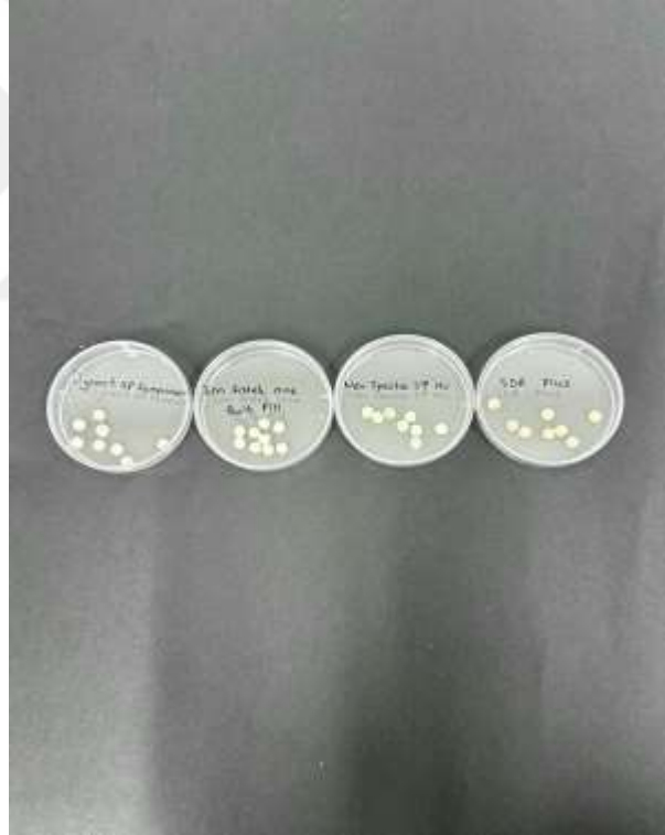
Şekil 3.20: Mikrosertlik Ölçümleri İçin Hazırlanan Restoratif Materyal Gruplarına Ait Disk Formundaki Örnekler.
