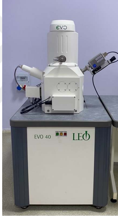
Resim 19. Analiz için kullanılan SEM/EDX cihazı (LEO-EVO40, Cambridge İngiltere)
