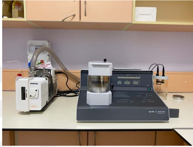
Resim 17. Au-Pd kaplama için kullanılan vakum cihazı (BAL-TEC SCD 050, Liechtenstein)
