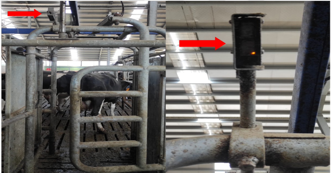
Şekil 2.5. Robotik sağım sistemine yerleştirilen VKS belirlenmesinde kullanılan kamera (Kırmızı ok).
