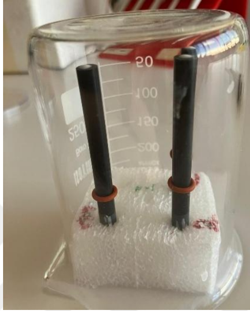
Şekil 3.4. Yağsız süt ile Au uçları kapatılmasının amaçlandığı bloklama işlemi için inkübasyona bırakılan çalışma elektrotları
