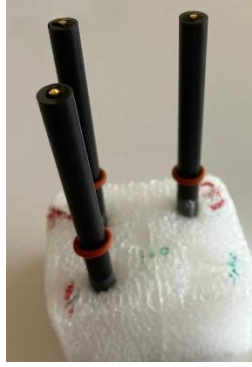
Şekil 3.3. SH-Aptamerin Au uçlarına bağlanması amacıyla, inkübasyona bırakılan çalışma elektrotları
