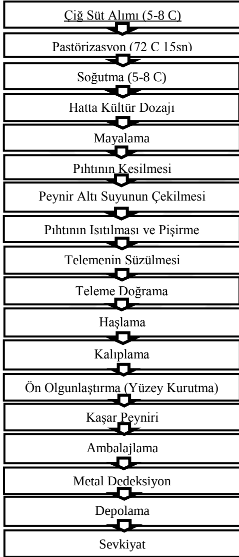
Şekil 2.6. Kaşar peyniri üretim akış şeması, (AK-PA ŞAVAK)
