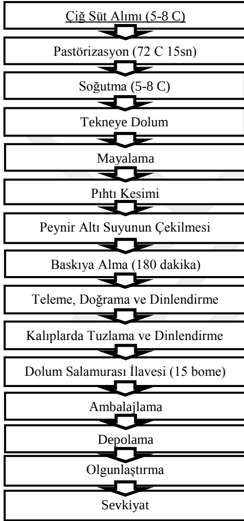
Şekil 2.5. Tulum peyniri üretim akış şeması, (AK-PA ŞAVAK)
