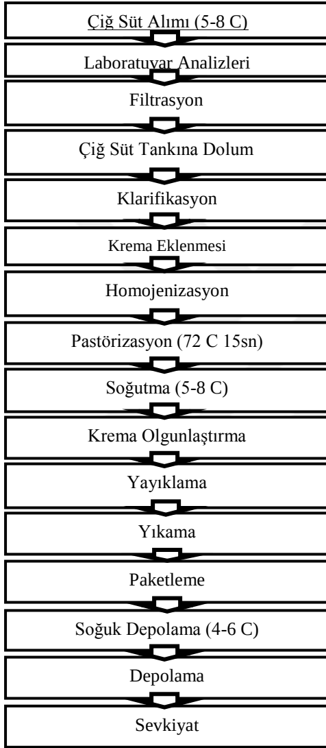
Şekil 2.1. Tereyağı üretim akış şeması, (AK-PA ŞAVAK)
