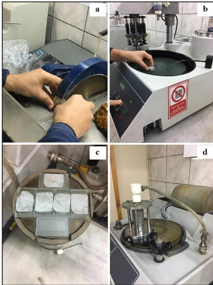
Şekil 3.4. İnce kesit hazırlama aşamaları a)taş kesme b) aşındırma c) yapıştırılan kireçtaşı d) zımparalama işlemi
