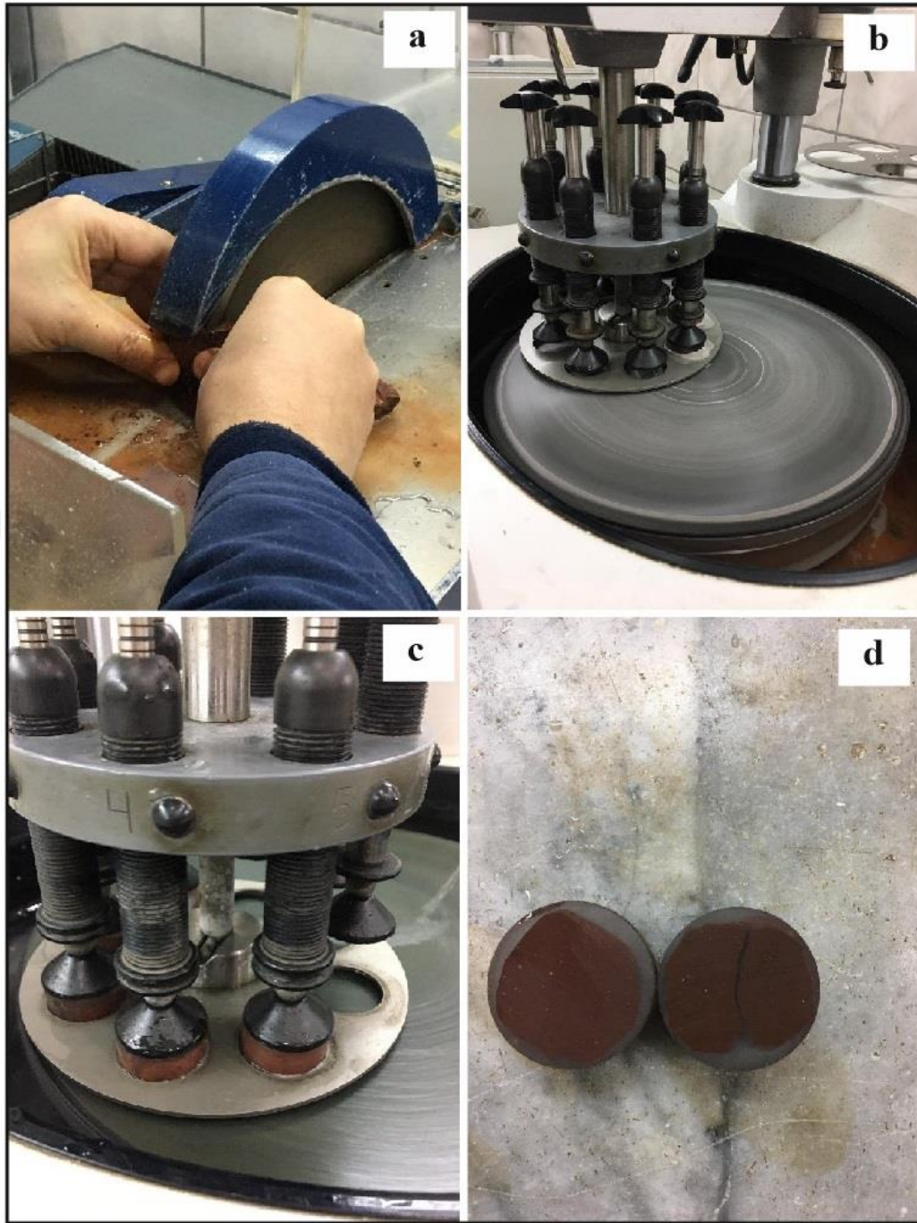
Şekil 3.5. Parlak kesit hazırlama işlemleri a) kesme aşaması b) zımparalama işlemi c) farklı çuhalar kullanılarak zımparalama işlemi d) parlatma işlemi
