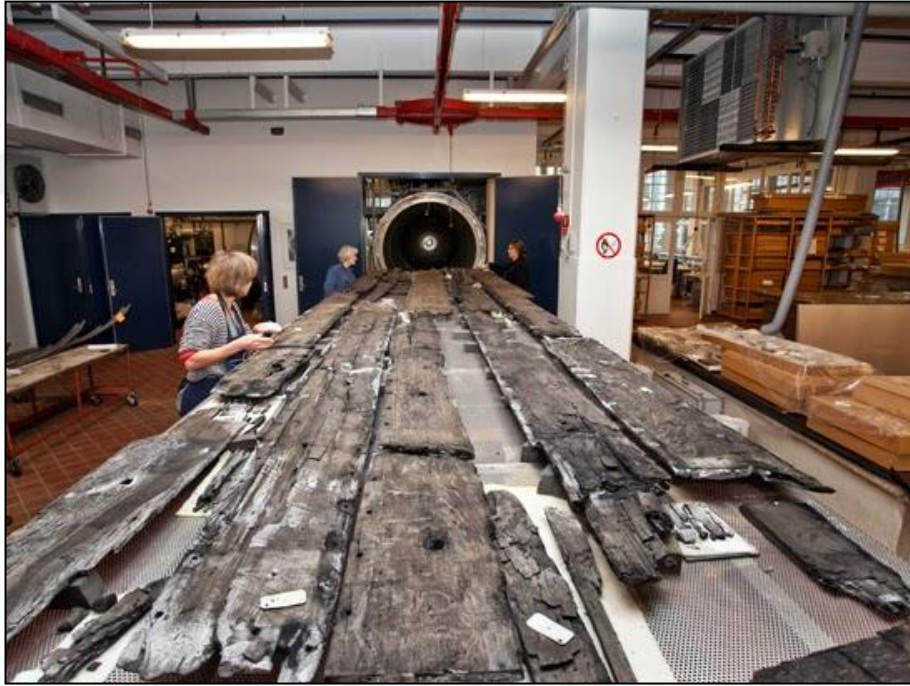
Şekil 4.1: Danimarka Ulusal Müzesi'ndeki büyük dondurarak kurutma cihazında Roskilde 6 Batığının kurutulması.
