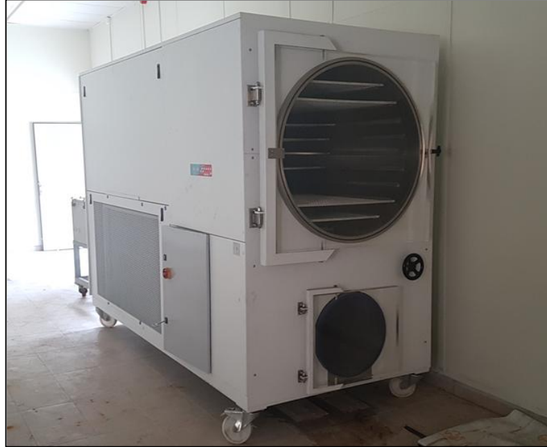
Şekil 2.2: Vakumlu dondurarak kurutma cihazı.
