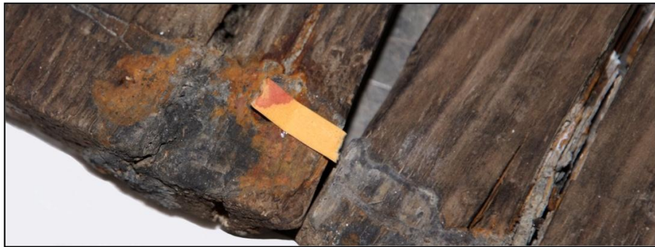
Şekil 1.15: PEG ile işlem görmüş ve dondurularak kurutulmuş, asidik (pH göstergesi kağıdına bakınız) suya doymuş ahşap örneği.
