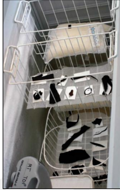
Şekil 2.8: Ev tipi dondurucuda yapılan dondurarak kurutma işlemi.
