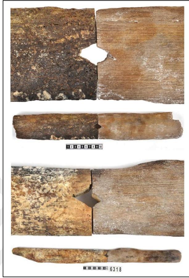
Şekil 4.15: DTPA'da ekstraksiyon işlemi ardından PEG emdirme ve dondurarak kurutma işleminden önce (solda) ve sonra (sağda) iki ahşabın görünümü.
