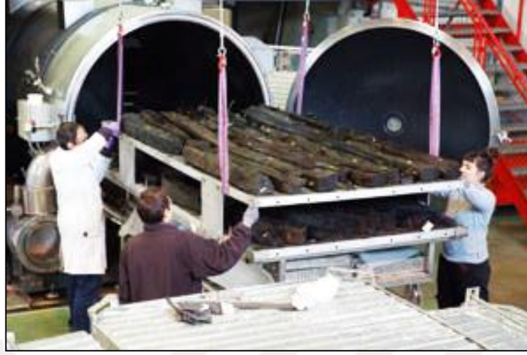
Şekil 4.7: Antibes batığı ahşaplarının dondurarak kurutma işlemi.
