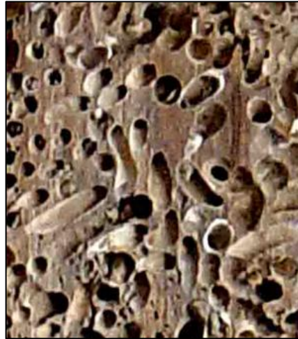
Şekil 1.10: Teredo navalis 'in ahşaba verdiği zarar.
