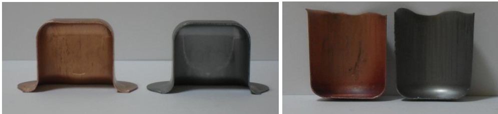
Resim 5.9. Et kalınlığı ölçümü için kesilmiş deney numuneleri
