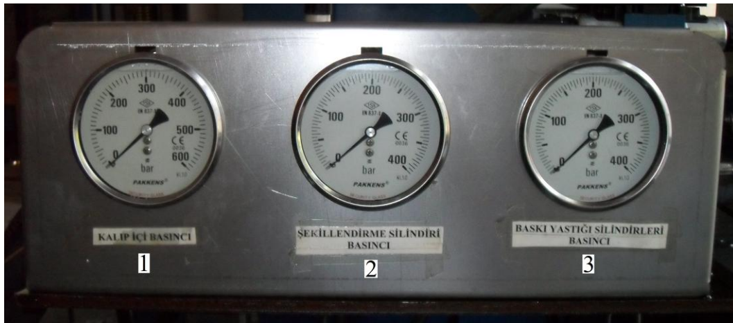
Resim 4.8. Manometrelerin deney düzeneğindeki bağlantı görüntüsü.
