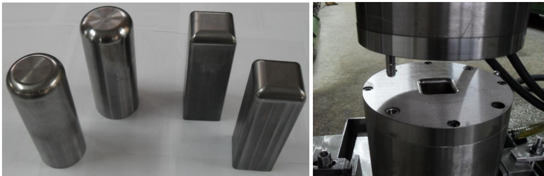
Resim 4.12. İmalatı yapılan kalıp zımbaları ve deneysel çalışma ortamı görüntüleri
