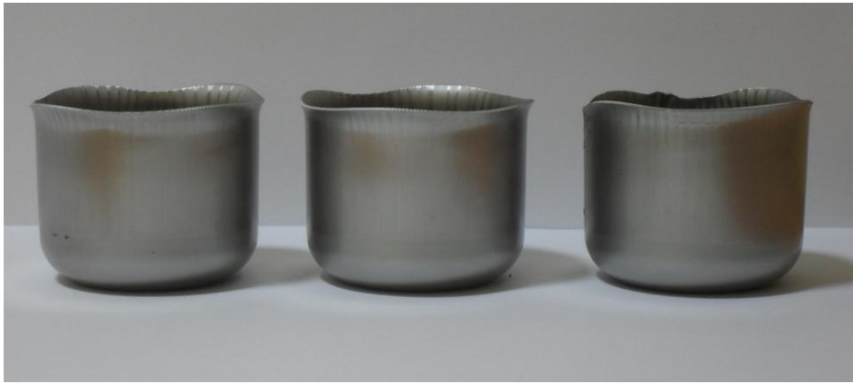
Resim 5.7. AISI 304 sac malzemedan şekillendirilmiş parçalar, çekme oranı: 2,0 D = 120 \text{ mm} , t = 0,8 \text{ mm} , p = 200 \text{ MPa}
