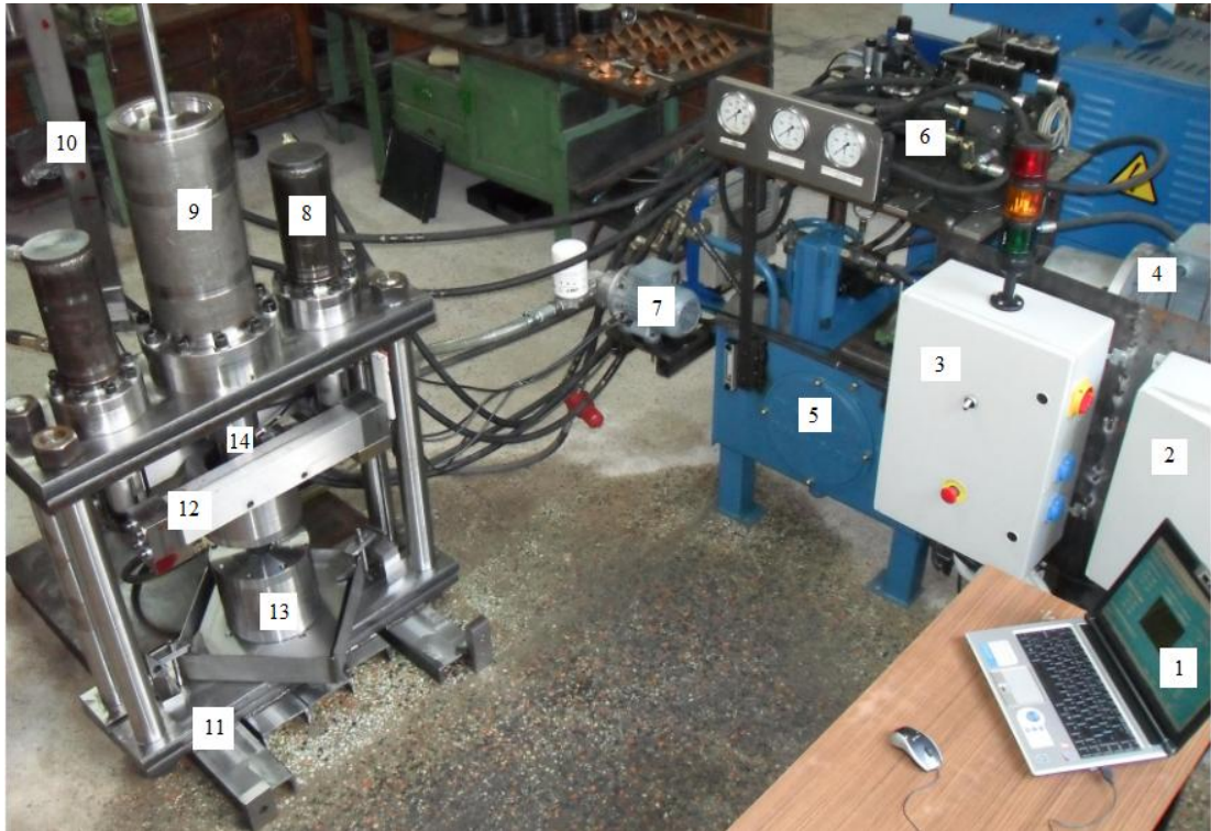
Resim 4.5. Hidromekanik derin çekme deney düzeneği.
