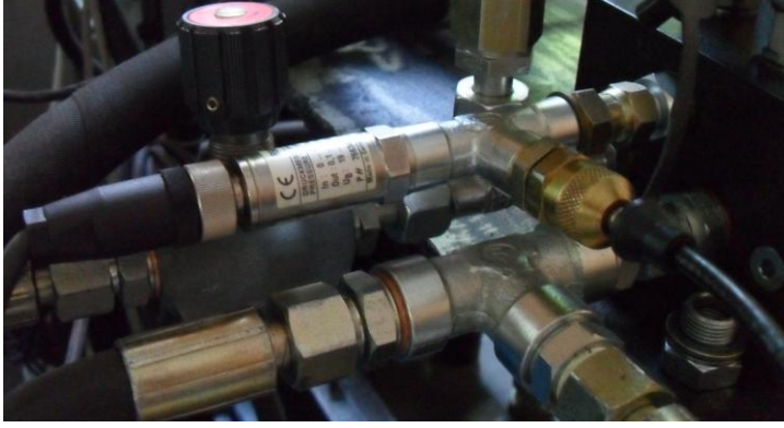
Resim 4.9. Basınç transdüseri deney düzeneği bağlantısı.
