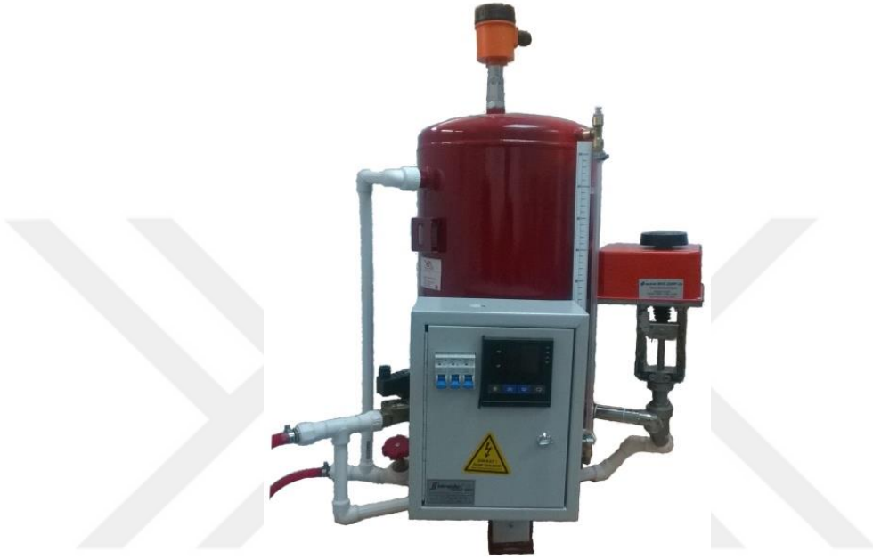
Şekil 4. 2. Sıvı seviye kontrol sistemi
