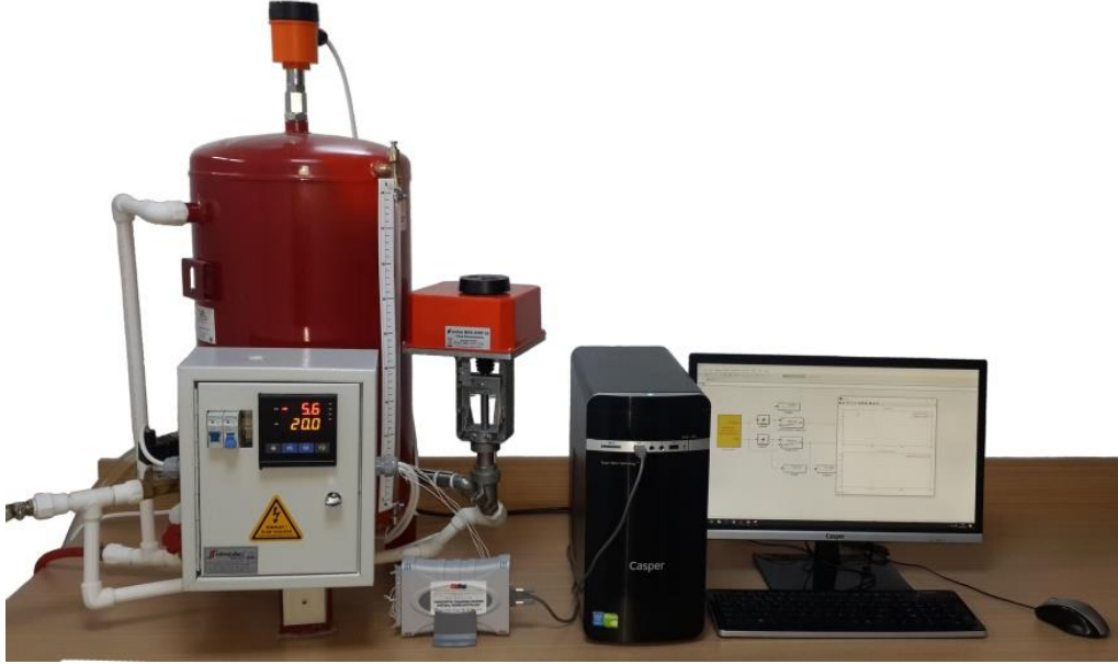
Şekil 4. 22. Sıvı seviye kontrol sistemi
