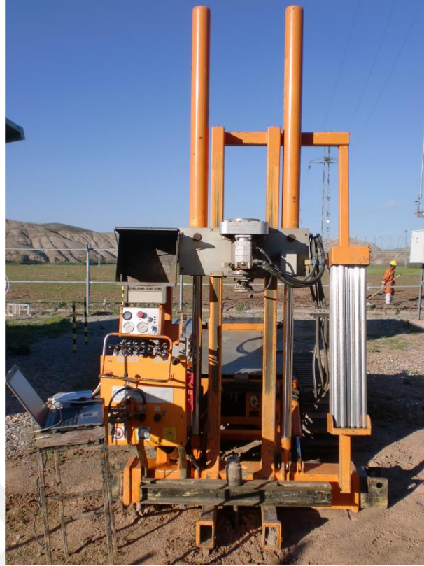
Şekil 4.3. Sakarya Üniversitesine ait paletli koni penetrasyon deney aleti.
