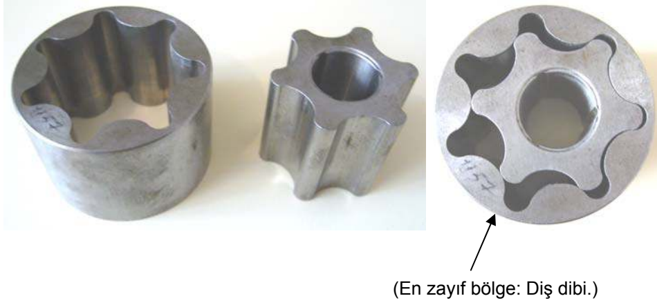
Şekil 7.1. 1156-1157 gerotor dişli takımı.
