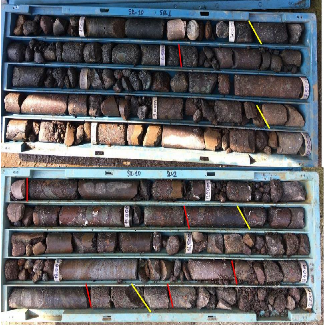
Şekil 7. SK-10 nolu araştırma sondajına ait karot sandıkları
