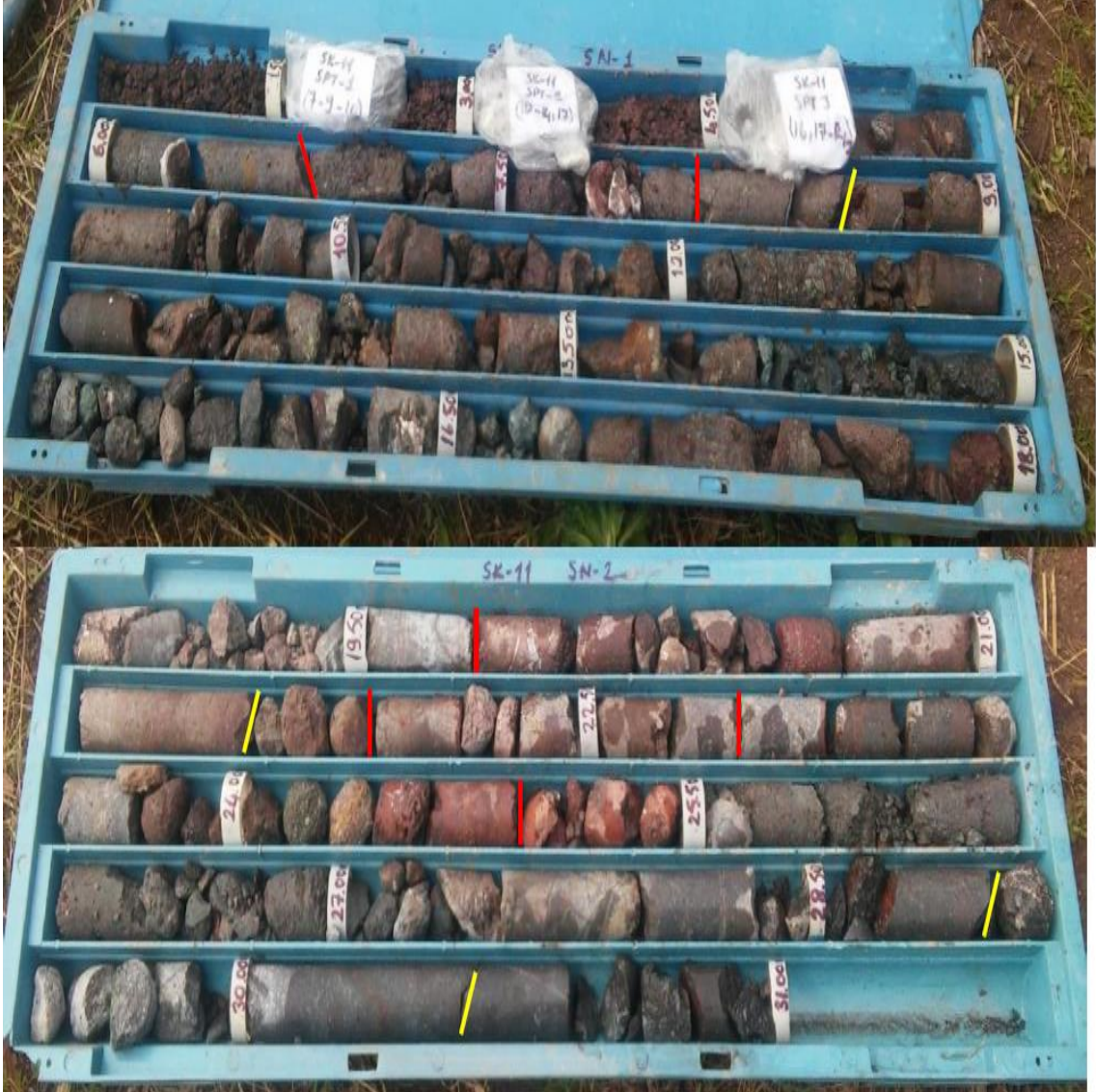
Şekil 8. SK-11 nolu araştırma sondajına ait karot sandıkları
