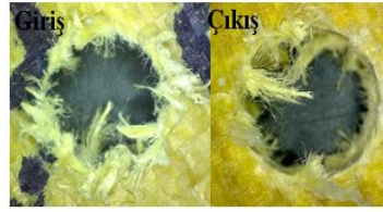
Aramid elyaf kompozit malzeme 6mm çaplı HSS matkap, 2500 dev/dk. Devir, 750 mm/dk. İlerleme
