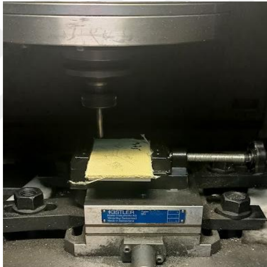
Şekil 4.3: Deney Düzeneği ve Dinamometre
