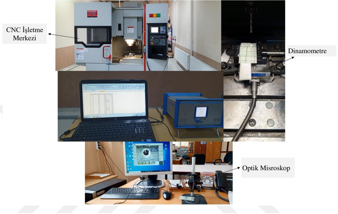
Şekil 4.7: Delme Deneylerinin Yapılması, Kesme Kuvvetlerinin Ölçülmesi ve Yüzey Fotoğraflarının Alınması
