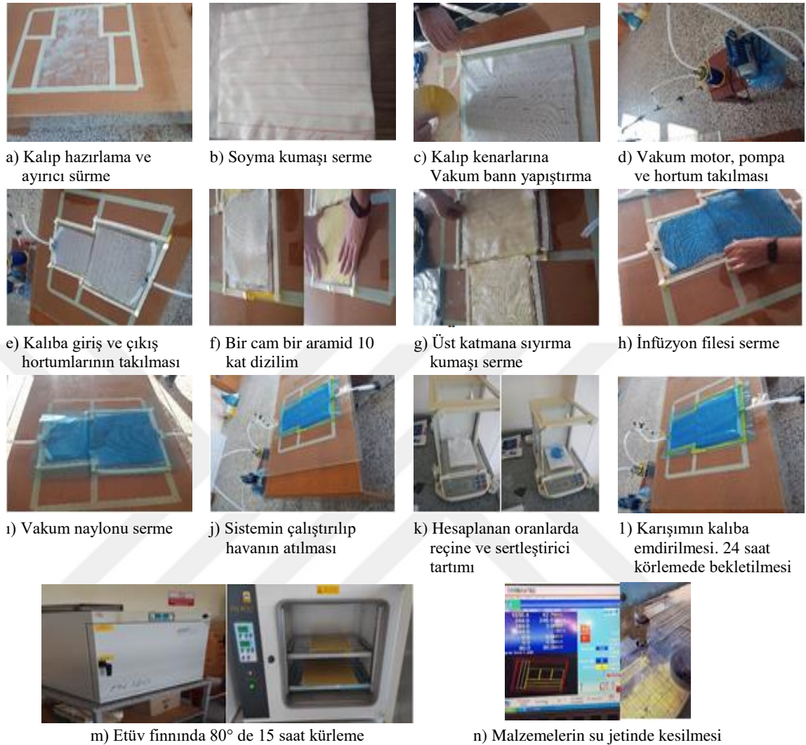
Şekil 3.1: Vakum Destekli Reçine Transfer Yöntemi ile Üretilmiş Tabakalı Hibrit Kompozit (Cam-Aramid) Malzeme İşlem Sırası a, b, c, d, e, f, g, h, i, j, k, l, m, n
