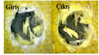
Hibrit kompozit malzeme 6mm çaplı karbür matkap ile 2000 dev/dk. Devir, 8000 mm/dk. İlerleme
