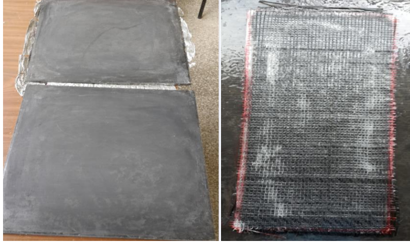
Şekil 3.4. Kullanılan kalıp ve reçine sürülmüş elyaflar
