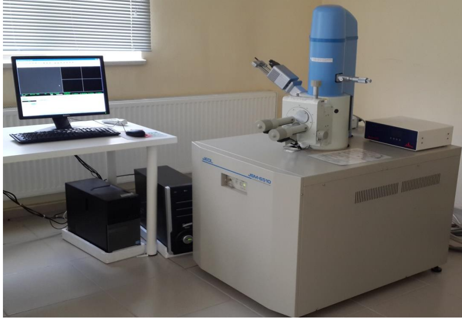
Şekil 4.33. SEM analizlerinde kullanılan elektron mikroskobu
