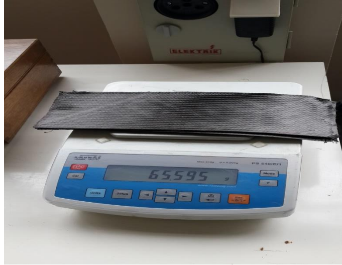
Şekil 3.3. Elyaf ağırlık ölçümünde kullanılan hassas terazi
