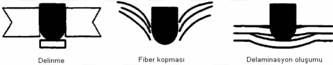
Şekil 5.3 Balistik darbe sırasında oluşan belli başlı hasar türleri [94]
