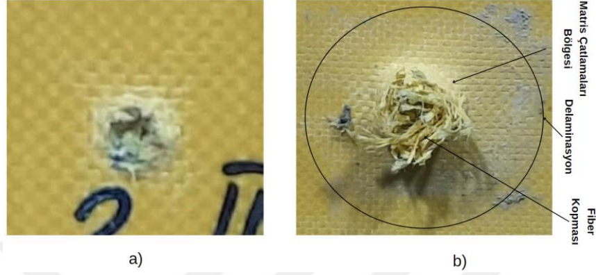
Şekil 7.22 20 Tabakalı Kevlar/Epoksi kompozit levhanın IIIA seviyesi hasar görüntüsü a) ön yüz b) arka yüz
