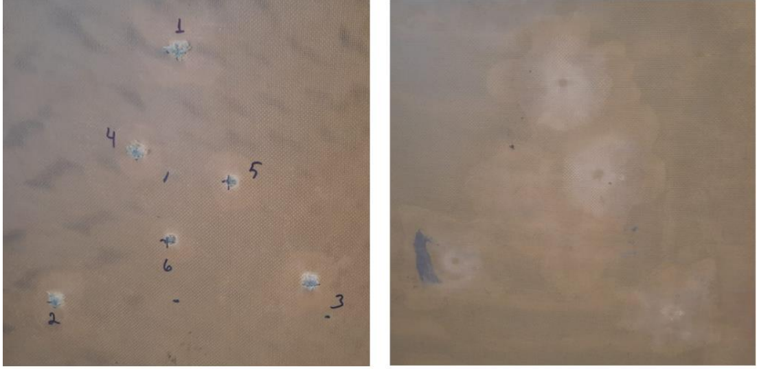
Şekil 7.8 %0,125 B 4 C atış yapılmış kompozit levha a) Ön yüz b) Arka yüz
