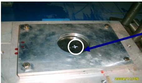
Resim 5.30. Levhanın darbe içine hazırlanması
