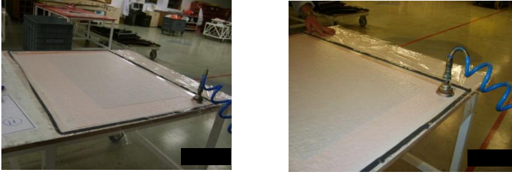
Resim 5.5. Malzeme serimi ve ara vakum işlemi
