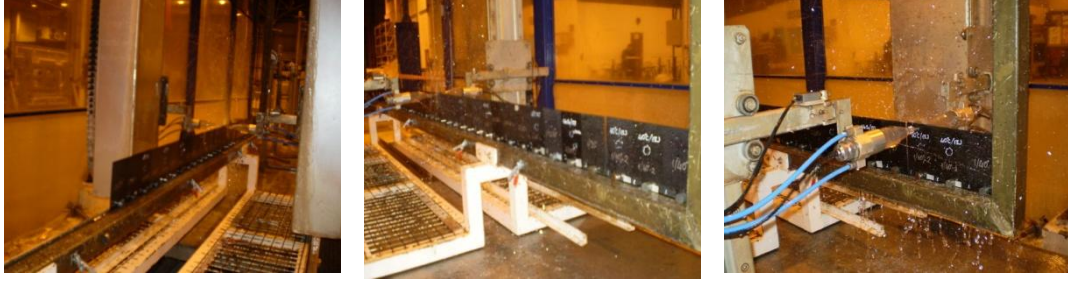
Resim 6.1. Levhaların C-Scan'e yerleşimi ve taranması
