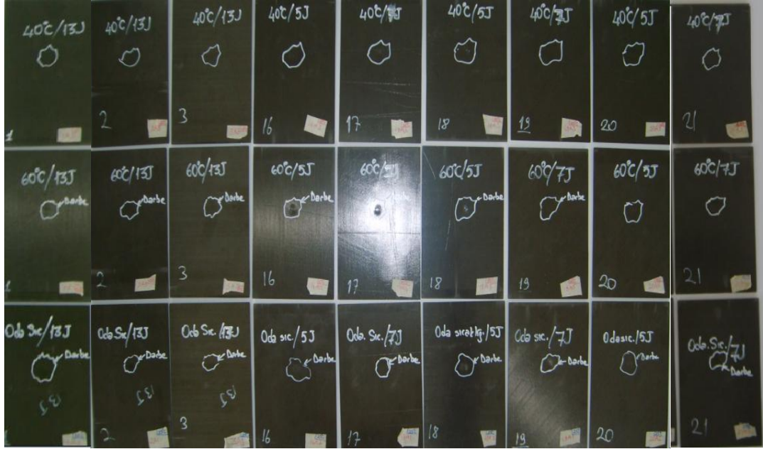
Resim 5.25. +40°C ve +60°C’ deki darbe uygulanmış numuneler
