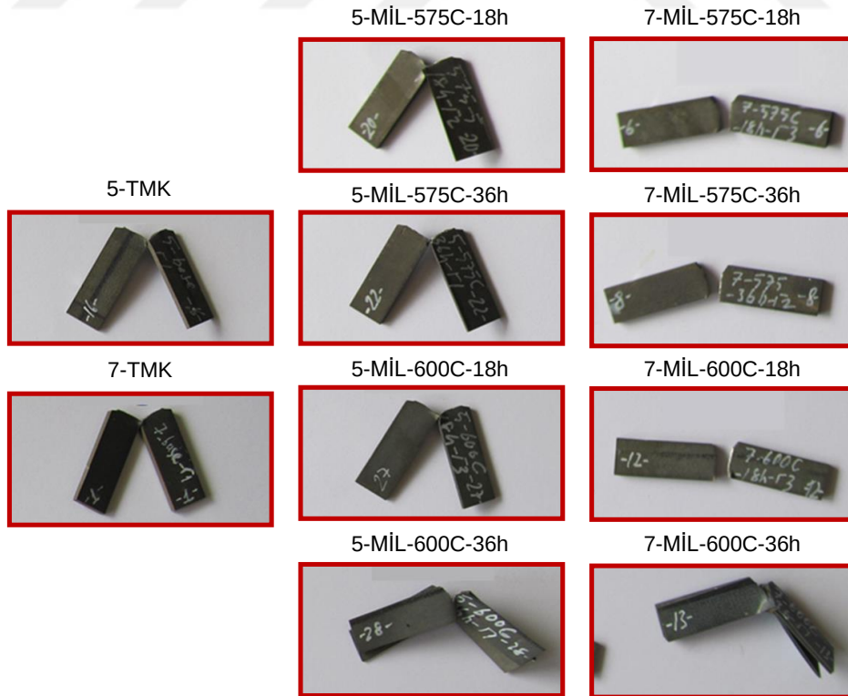
Şekil 58. Çentik darbe deneyine tabi tutulmuş 5-TMK, 7-TMK ve farklı sıcaklık ve sürelerde üretilmiş MİL numunelerin deney sonrası görüntüleri
