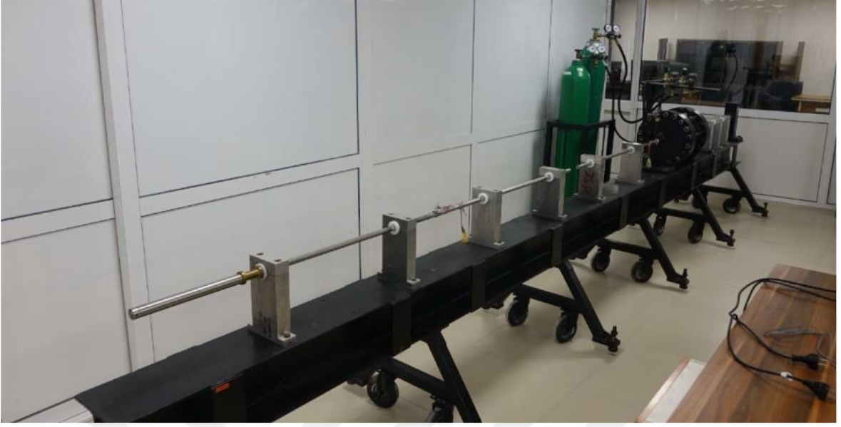
Şekil 19. Split-Hopkinson çekme çubuğu (SHÇÇ) test düzeneği (İYTE-DTMLab)
