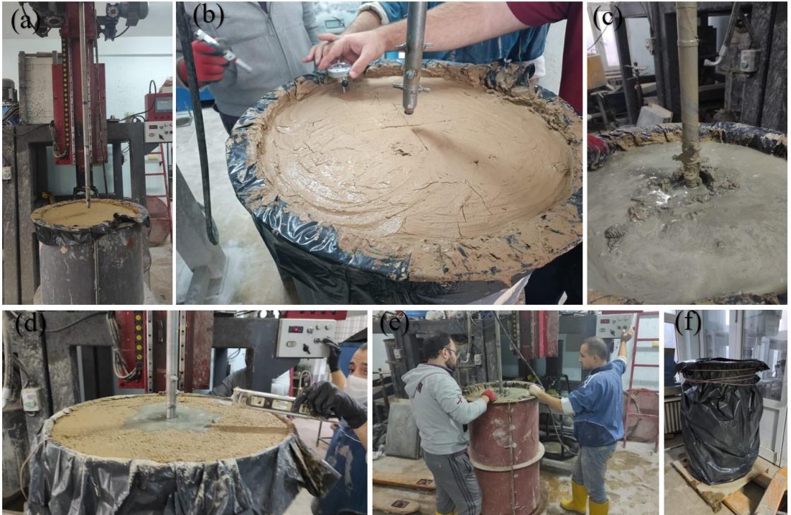
Şekil 3.73. a), b) Tankın hizalanması, c, d), e) derin karıştırma kolonlarının oluşturulması, f) yükleme deneylerine kadar küre bırakılması.
