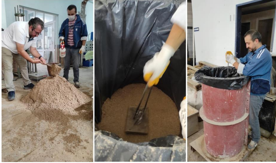
Şekil 3.67. Kumlu zeminin istenilen su muhtevasında karıştırılması ve tanka yerleştirilmesi.
