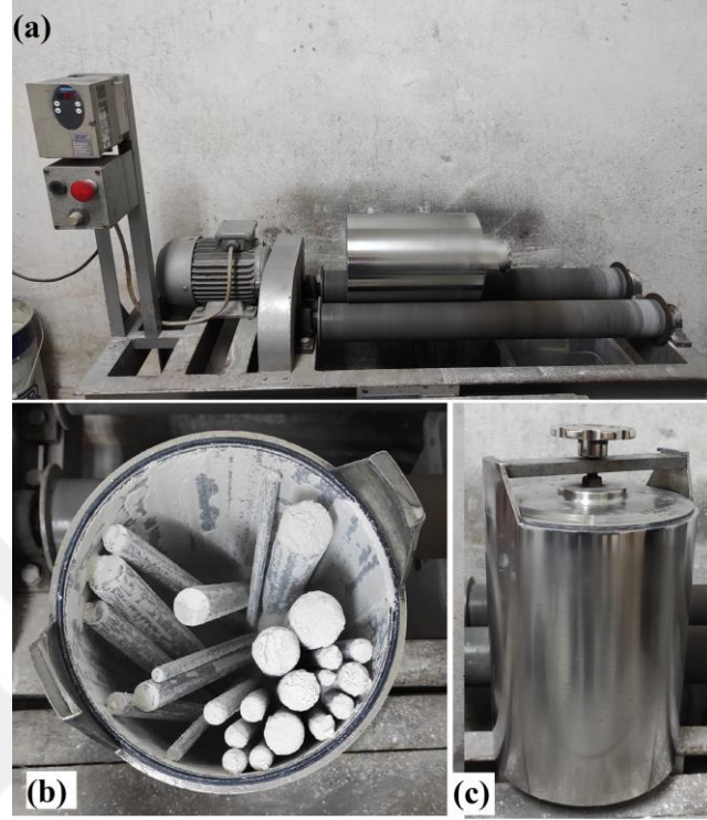
Şekil 3.30. a) Devirme mekanizmalı değirmen, b) çelik çubuklar, c) hazne.
