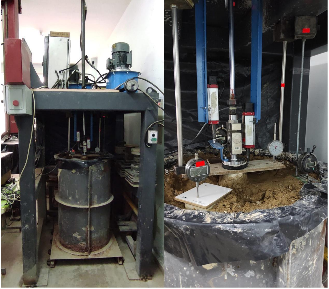
Şekil 3.75. Deneylerde kullanılan yükleme düzeneği.
