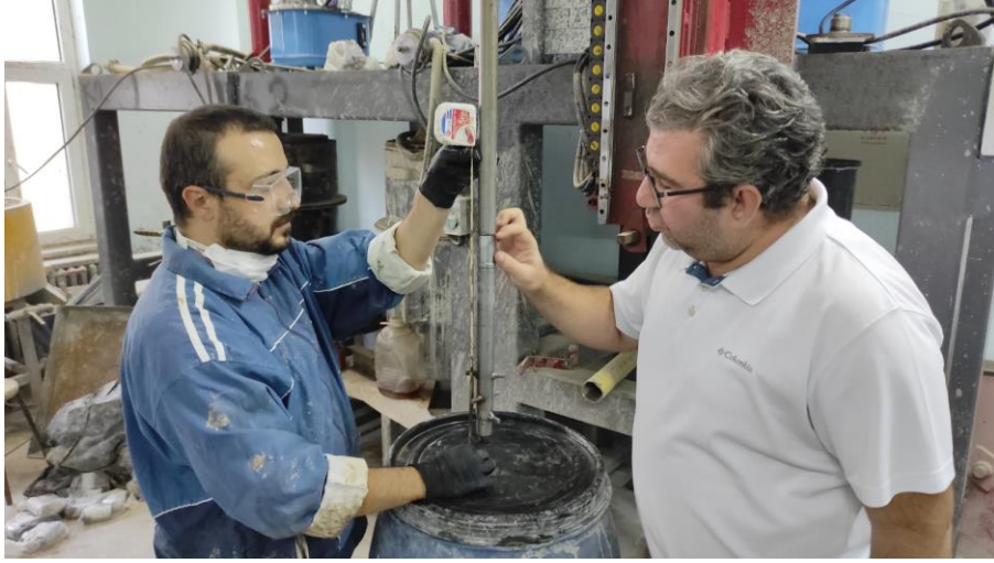
Şekil 3.69. Derin karıştırma makinesi şaft batma hızı kalibrasyonu.
