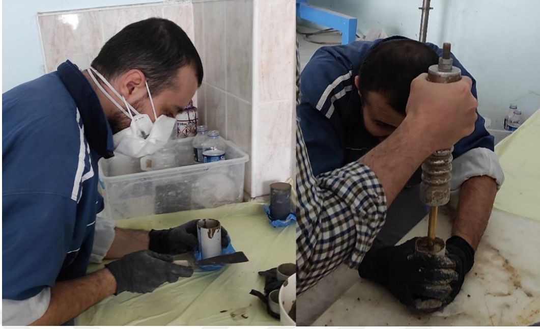
Şekil 3.47. Karışımların PVC kalıplara yerleştirilmesi.
