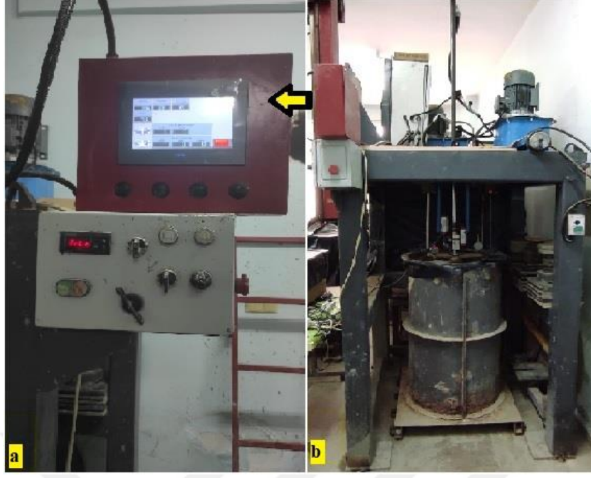
Şekil 3.38. a) Dijital dokunmatik pano, b) Yeni yükleme düzeneği.
