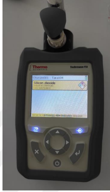
Şekil 3.16. Trudefender FTX cihazı ile analiz.
