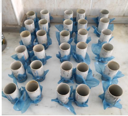
Şekil 3.26. Dayanım deneyleri için PVC numune kalıpları.
