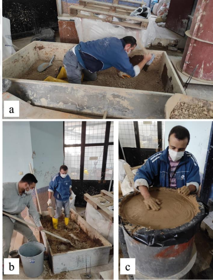
Şekil 3.66. a) Kil zeminin parçalanması, b) kil zeminin istenilen su muhtevasında karıştırılması ve ezilmesi, c) zeminin tanka yerleştirilmiş hali.
