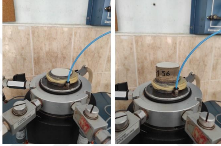
Şekil 3.56. Filtre kâğıdı ve numunenin yerleştirilmesi.
