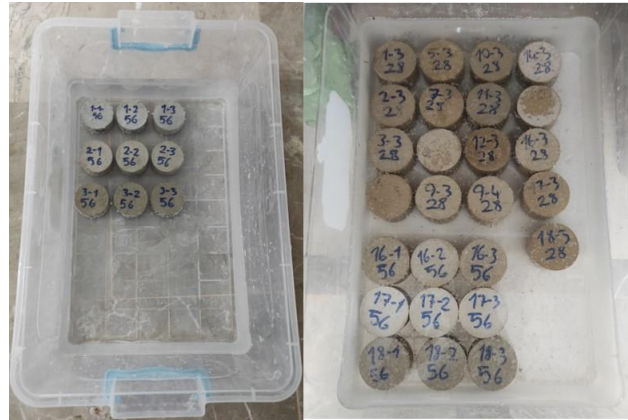
Şekil 3.54. Kür süreleri sonunda suya doymun hale gelmesi için suya bırakılan numuneler.
