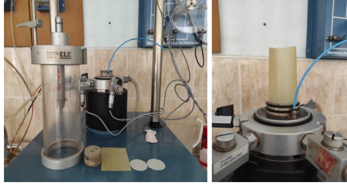
Şekil 3.55. Permeabilite deney düzeneği ve parçaları.
