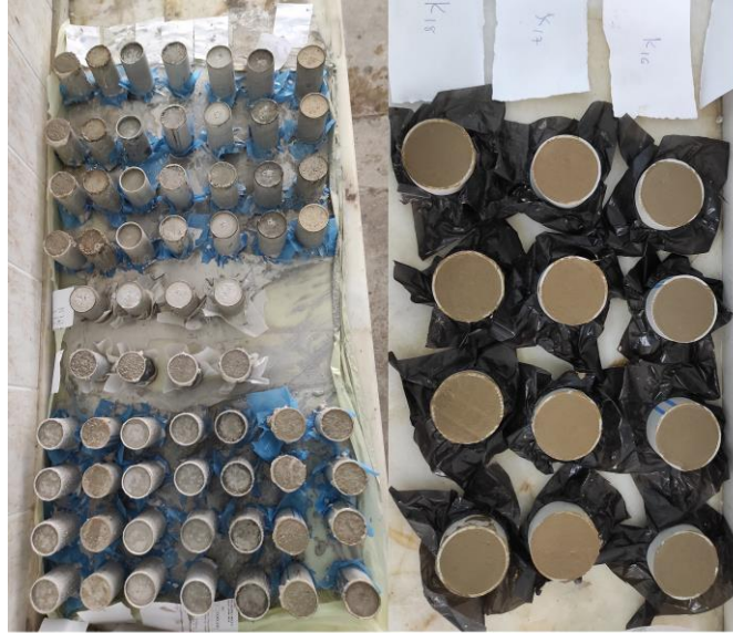
Şekil 3.46. Serbest basınç ve permeabilite deneyleri için mikserle hazırlanan numunelerin kalıplara yerleştirilmiş hali.
