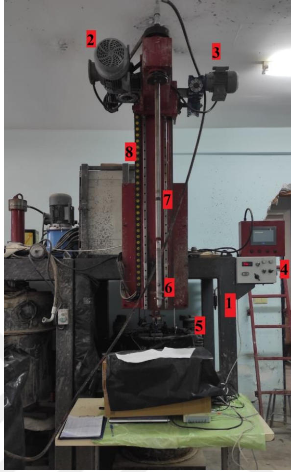
Şekil 3.32. Laboratuvar tipi derin karıştırma makinesi (1-şasi, 2-dönel hareket motoru, 3-düşey hareket motoru, 4-kontrol paneli, 5-deney tankı, 6-karıştırma bıçağı, 7- şaft, 8- kızak ve kramayer dişli).
