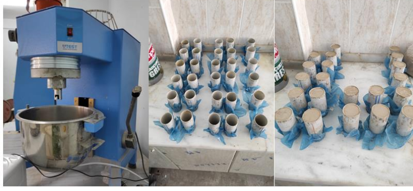
Şekil 3.45. Mikser, yağlanarak hazırlanan boş kalıplar, numuneler.
