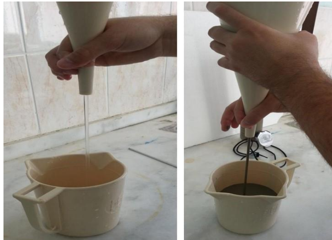
Şekil 3.63. Su ile kalibrasyon ve Marsh hunisi deneyi.
