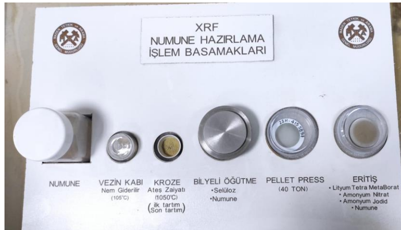
Şekil 3.60. XRF numune hazırlama işlem basamakları.
