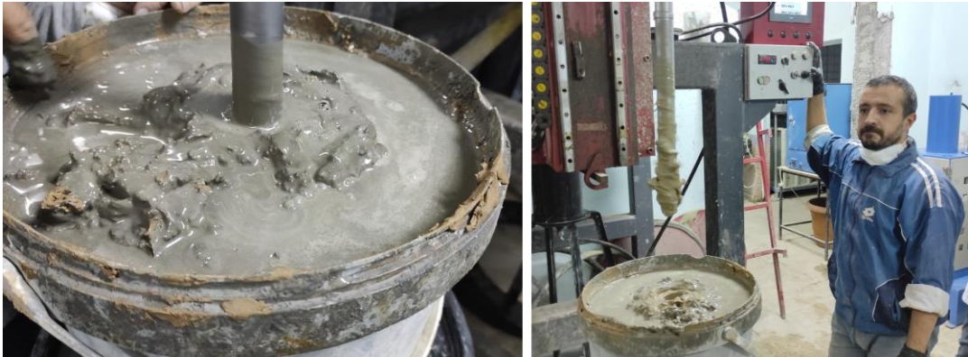
Şekil 3.70. Küçük tanklarda DKK imalatı.
