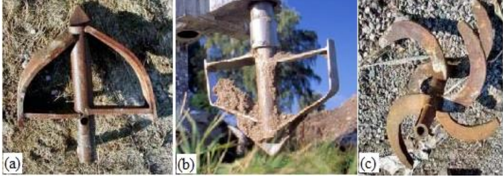
Şekil 2.13. Kuru karıştırma yönteminde kullanılan tipik karıştırma bıçakları: a) normal ve c) turba zeminler için (Topolnicki, 2004), b) Nordic karıştırma bıçağı (Larsson, 2005)
