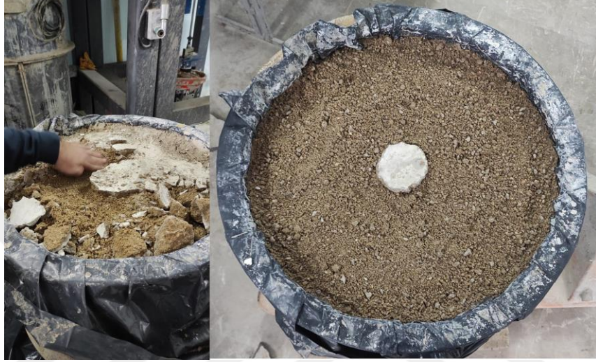
Şekil 3.74. Derin karıştırma kolonunun yüklemeye hazır hale getirilmesi.
