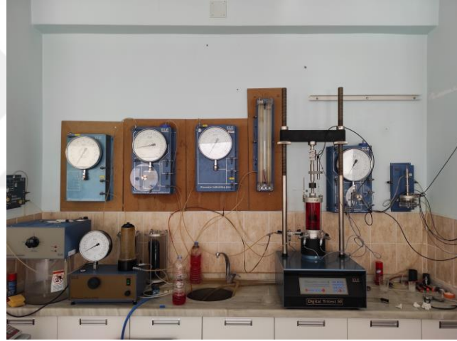
Şekil 3.53. Permeabilite deneyleri için kullanılan üç eksenli basınç deney düzeneği.
