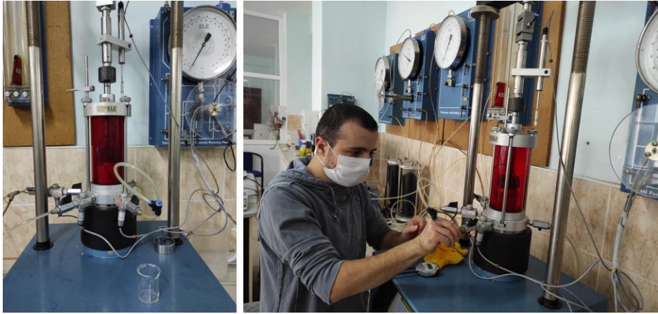
Şekil 3.58. Deneye hazır hale gelmiş numune ve deney düzeneği.
