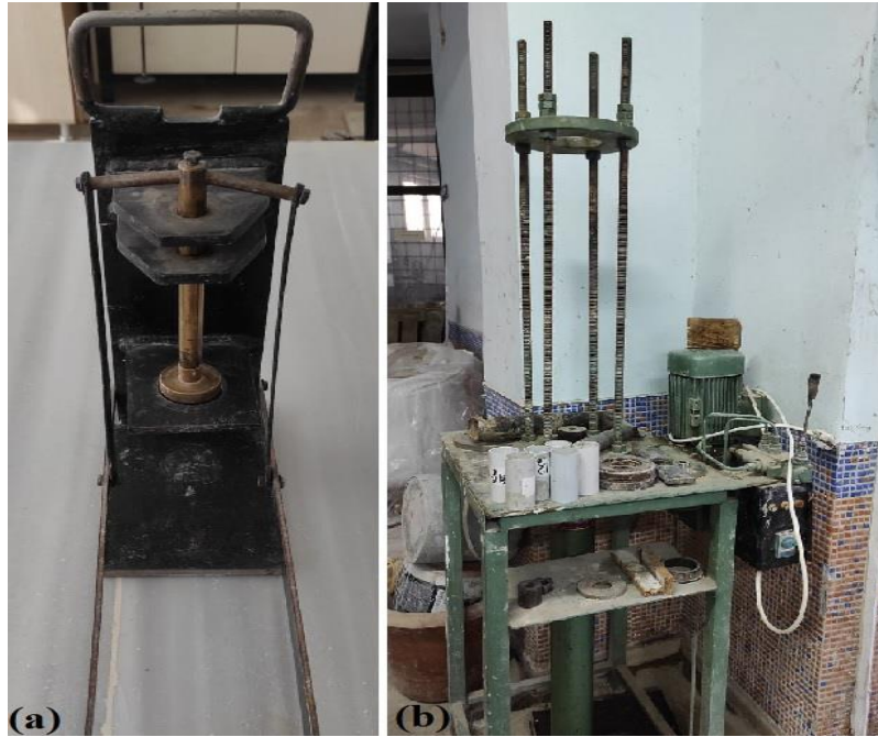
Şekil 3.28. a) Manuel numune çıkarıcı, b) hidrolik numune çıkarıcı.
