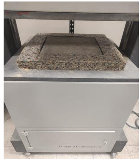
Şekil 4.14. 300 x 300 x 50 mm boyutlarındaki numunelerin etüvde kurutma ve ısı iletkenlik cihazında uygulama işlemi
