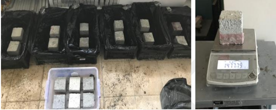
Şekil 4.11. Kılcal su emme testi
