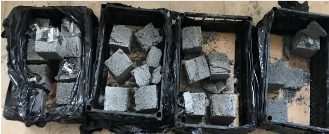
Şekil 4.3. 7. gün ve 28. gün basınç dayanımı test sonucu sonrası numune görselleri
