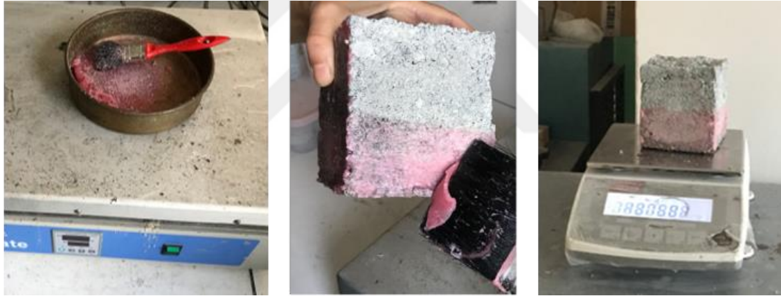
Şekil 4.10. Etüv kurusu numunelerin mumlama ve tartım işlemleri
