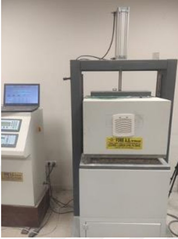
Şekil 3.27. Isıl iletkenlik testinde kullanılan Hot-plate cihazı
