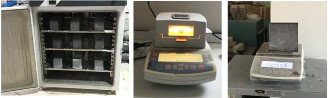
Şekil 4.7. Etüv kurusu, nem ölçüm ve etüv kurusu ağırlık tartım işlevleri
