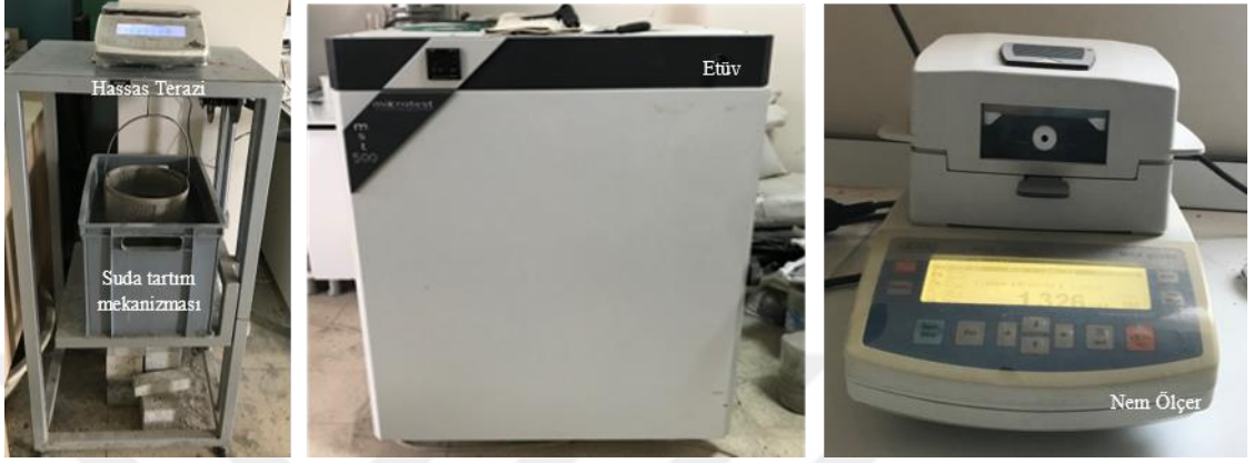
Şekil 3.26. Kuru birim ağırlık, suda tartım ve su emme testinde kullanılan cihazlar
