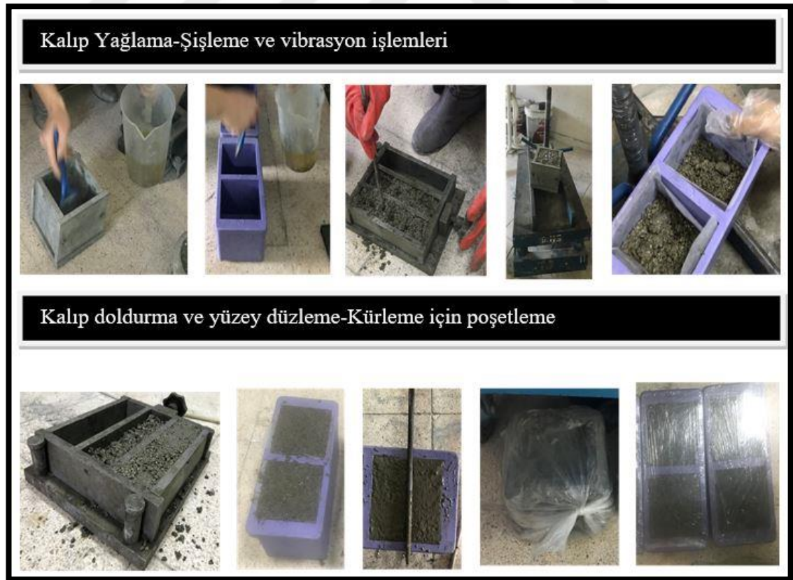
Şekil 3.9. Ön çalışma – Harcın kalıplara dökümü ve kalıplarla kürleme işlemi
