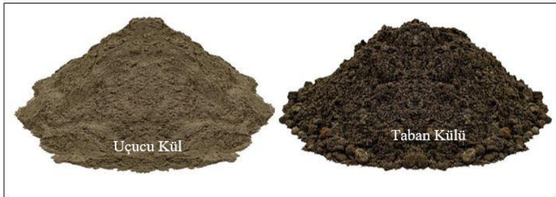
Şekil 2.9. Termik Santral kömür atığı olan uçucu kül ve taban külü (Anonim 4)
