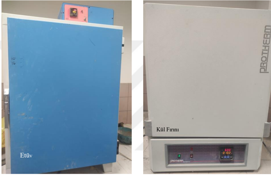
Şekil 3.28. Yüksek sıcaklık testinde kullanılan etüv ve kül fırını
