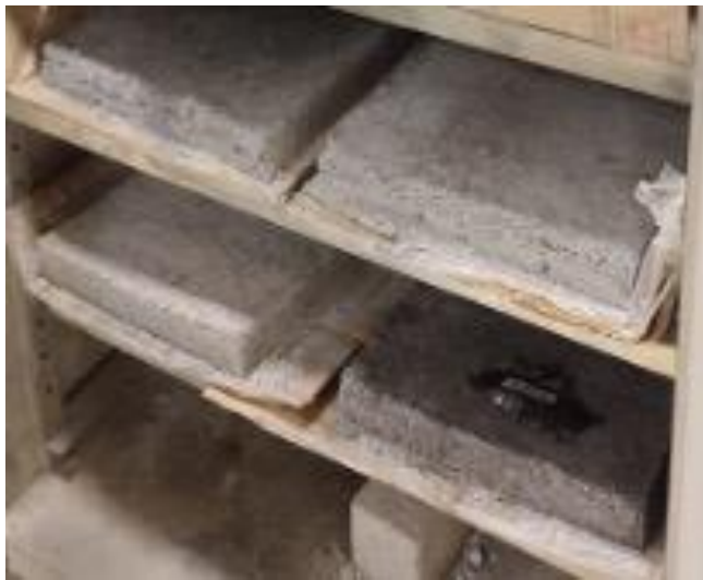
Şekil 4.14. 300 x 300 x 50 mm boyutlarındaki numunelerin etüvde kurutma ve ısı iletkenlik cihazında uygulama işlemi
