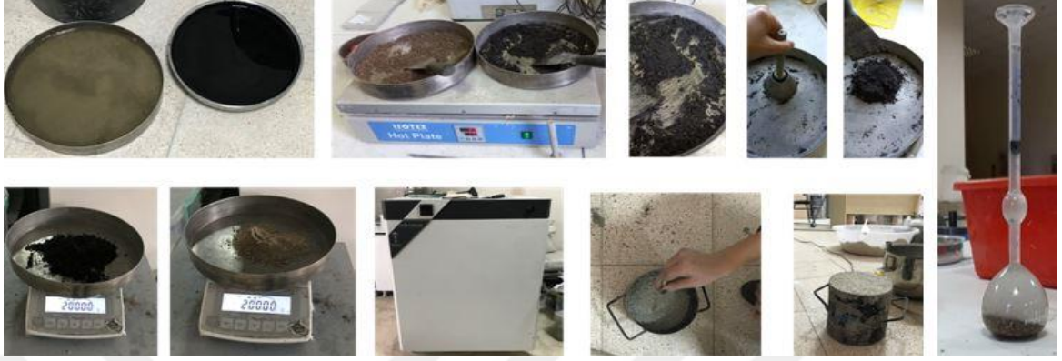
Şekil 3.6. Hava kurusu, etüv kurusu, doymun kuru yüzey kuru ve su emme ağırlıkları ve özgül ağırlık analizleri için kullanılan materyaller
