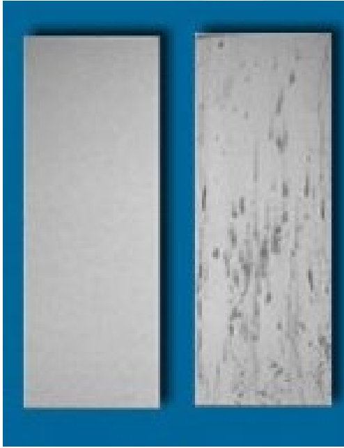
Şekil 4.7. 6061 T6 malzemenin korozyon testi öncesi ve sonrasına ait görsel
