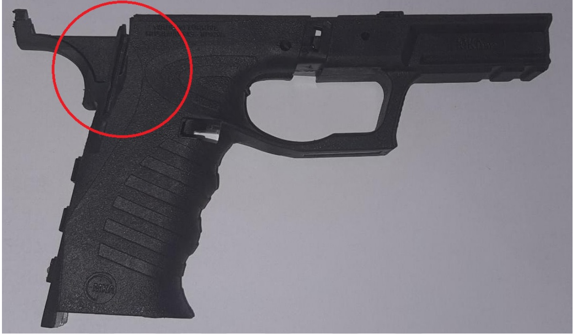
Şekil 2.1. Atışlar sonucu hasara uğramış tabanca gövdesi
