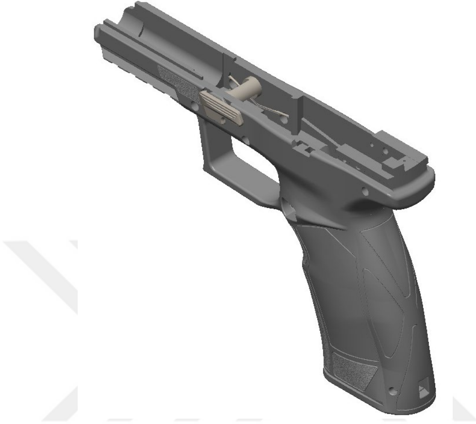
Şekil 27. Namlu kilidi ve gövde montajı
