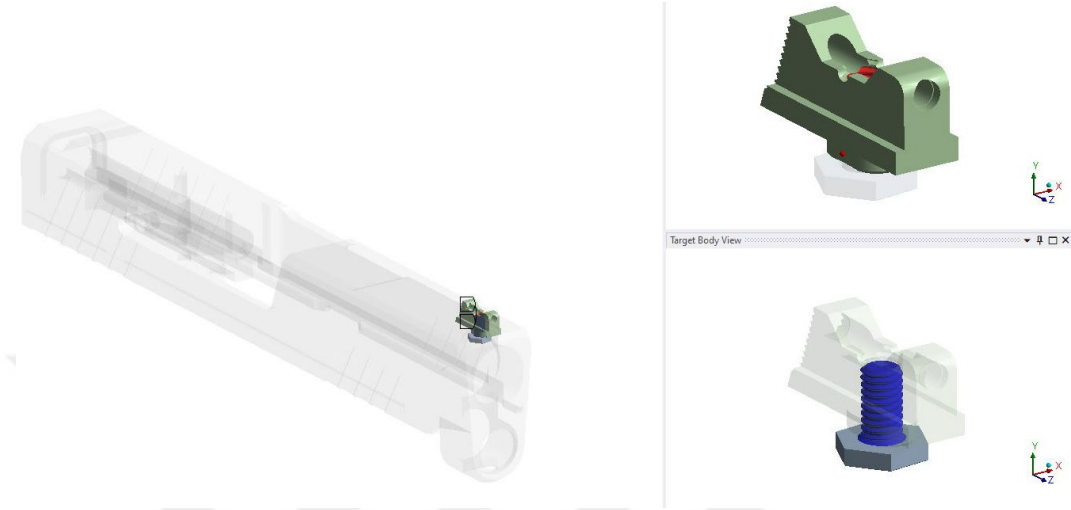
Şekil 24. Sonlu elemanlar analizinde arpacık ve vidaya uygulanan temas yüzeyleri
