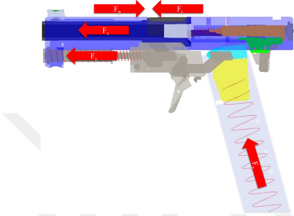
Şekil 5. PX9 GEN3 model tabanca için ateşleme esnasında meydana gelen kuvvetler (ön görünüş)
