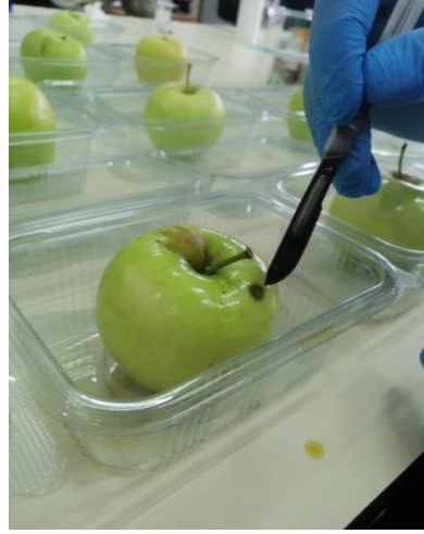
Şekil 3.12. Açılan yara kısımlarına fungus misellerinin yerleştirilmesi
