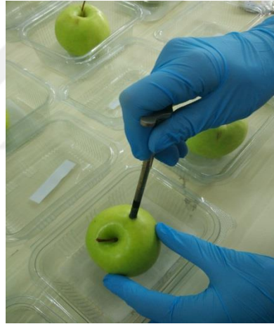
Şekil 3.10. Meyveler üzerinde mantar delici ile yara dokunun açılması
