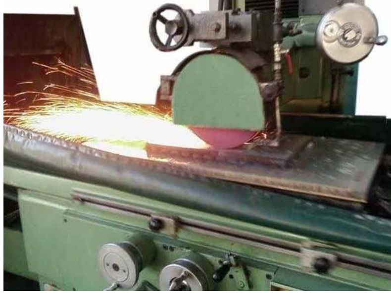
Şekil 3.4. Yatay Düz Yüzey Taşlama
