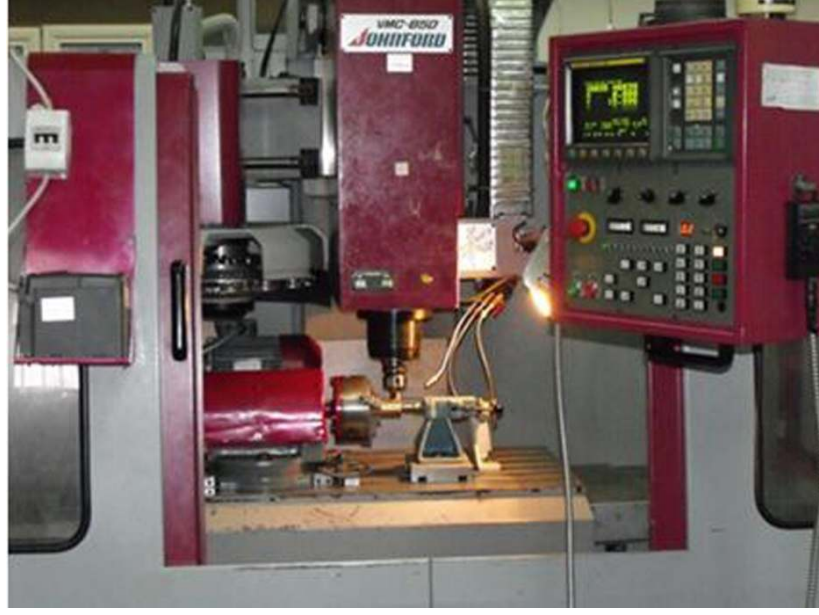
Şekil 4.1. Teğetsel silindirik taşlama deney düzeneği fotoğrafı
