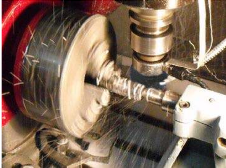
Şekil 4.2. Teğetsel silindirik taşlama yönteminde temas şekli
