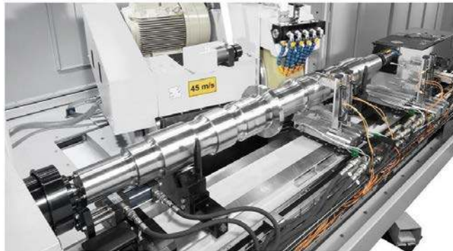
Şekil 3.7. Boyuna ve Enine Dış Yüzey Taşlama
