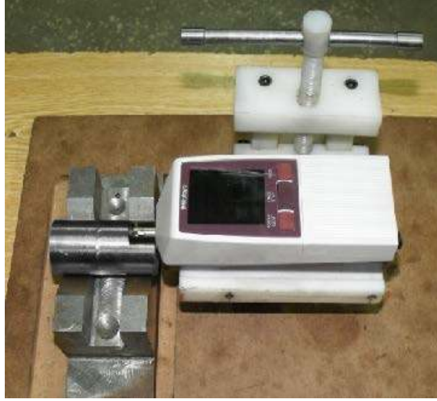
Şekil 4.5. Yüzey pürüzlülüğü ölçüm cihazı ve ölçüm düzeneği
