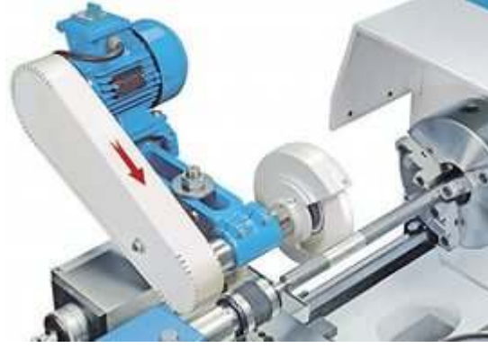
Şekil 3.6. Silindirik Dış Yüzey Taşlama
