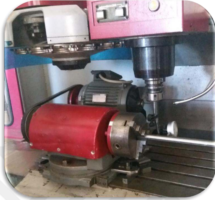
Şekil 4.4. Tornalama görevi gören düzenek
