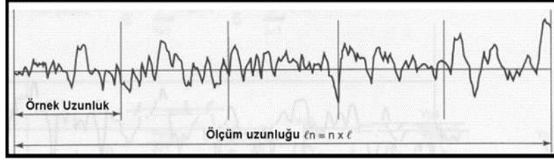
Şekil 3.20. Yüzey pürüzlülüğü ölçümü
