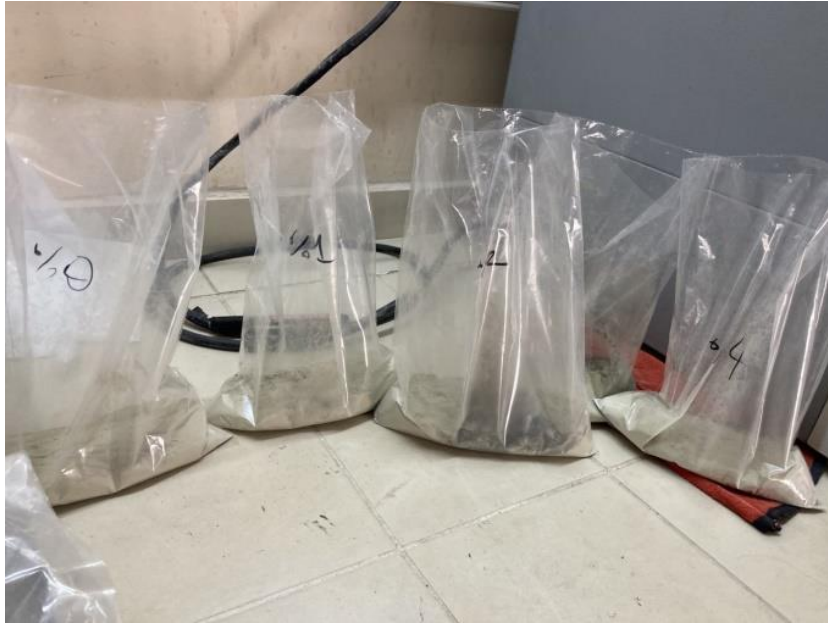
Şekil 3. 4. Kil’e Farklı Oranlarda Organik Madde İlave Edilerek Yapılan Karışımlar
