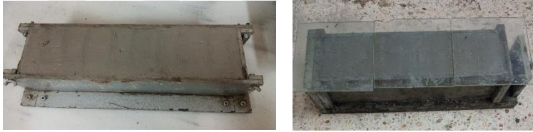
Şekil 37. Geopolimer harcın kiriş kalıplara yerleştirilmesi (a), kalıpların üzerinin cam ile örtülmesi (b)
