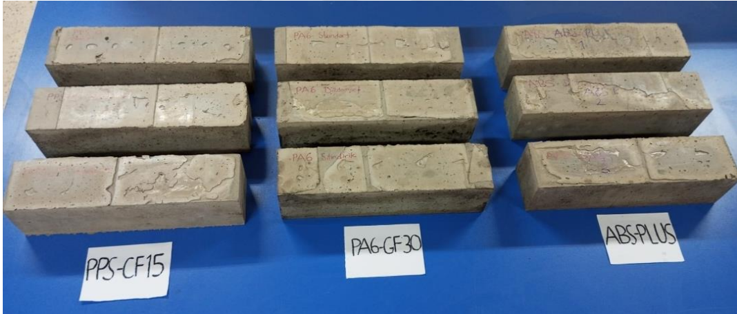
Şekil 39. Geopolimer harç numunelerin kiriş kalıplardan çıkarılması
