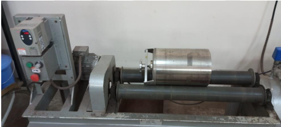
Şekil 12. Malzemelerin öğütüldüğü bilyalı öğütücü
