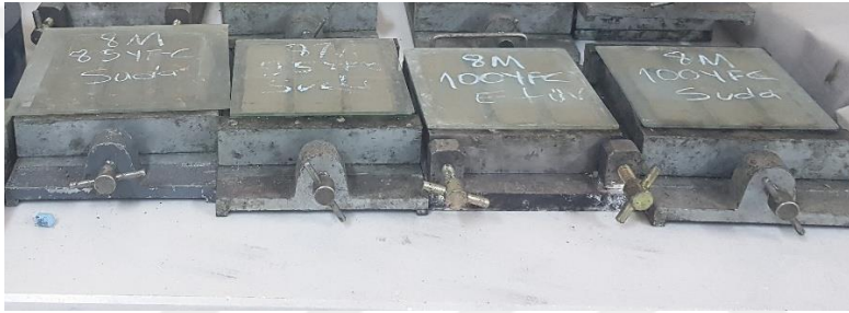
Şekil 43. Geopolimer numunelerin kalıplara yerleştirilmesi
