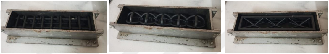
Şekil 36. Filamentlerin kalıplara yerleştirilmesi standart (a), küresel (b), çapraz bağlı (c)
