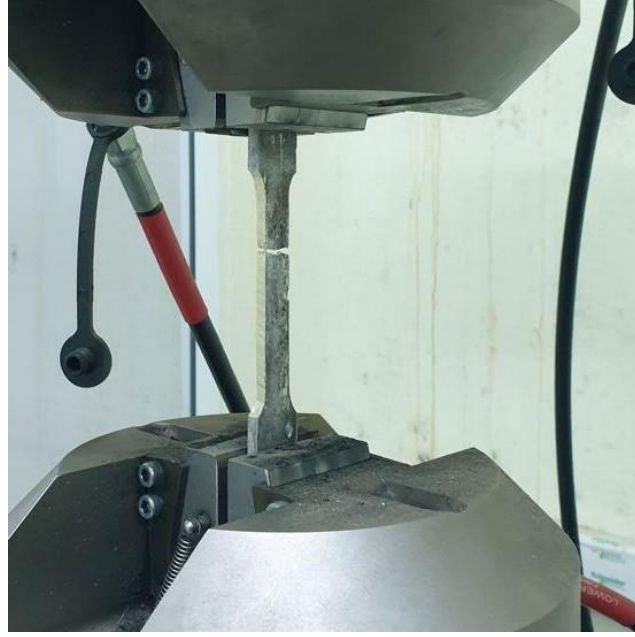
Şekil 4.12. Çekme deneyi cihazında test edilmiş test numunesi
