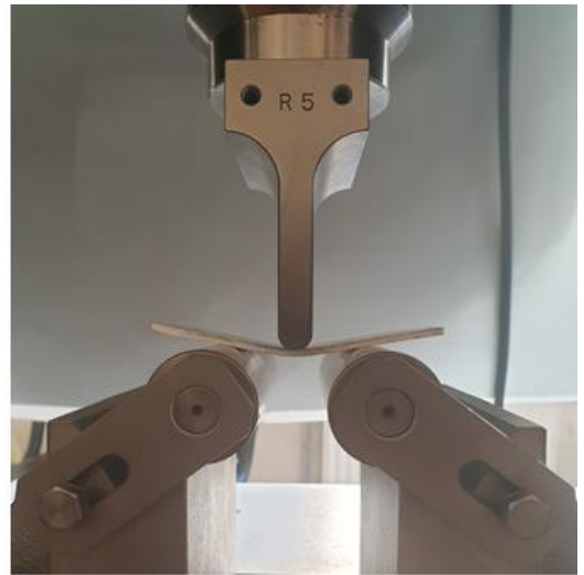
Şekil 4.22. Eğme test cihazında makineye yerleştirilmiş test numunesi
