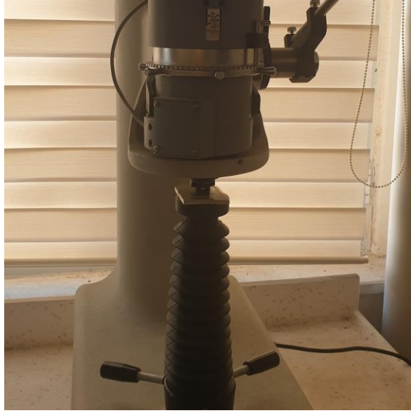
Şekil 4.28. ERNST AT 250 marka sertlik deneyi cihazında test edilen deney numunesi
