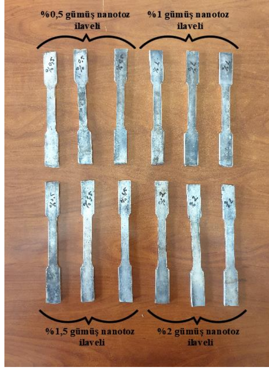
Şekil 4.10. Çekme deneyi için 20 nm gümüş nanotoz ilaveli 925 ayar alaşım gümüş numuneleri
