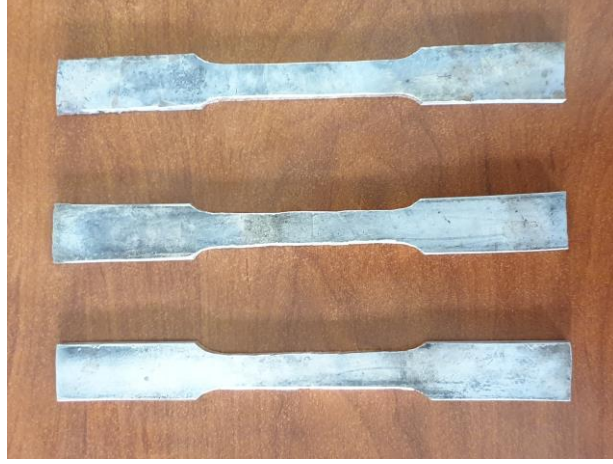
Şekil 4.6. Çekme deneyi için 925 ayar alaşım gümüş numuneleri
