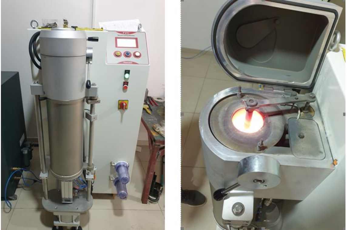
Şekil 4.9. Vakumlu döküm makinası ve eritme haznesi
