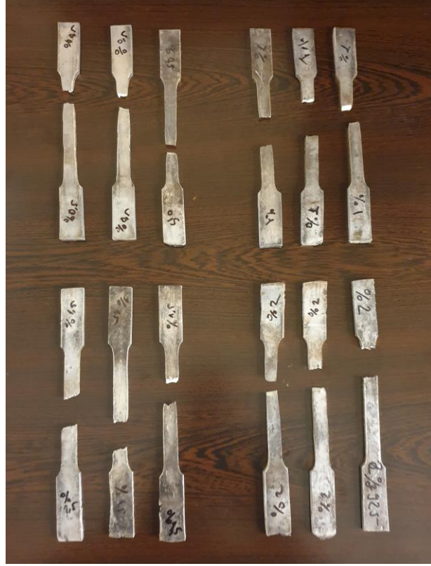
Şekil 4.14. Çekme deneyi cihazında test edilmiş ikinci grup numuneler
