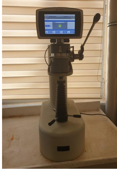
Şekil 4.27. ERNST AT 250 marka sertlik deneyi cihazı
