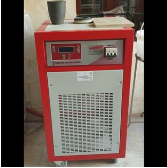
Şekil 4.4. İndüksiyonlu döküm makinası ve astar kalıbı
