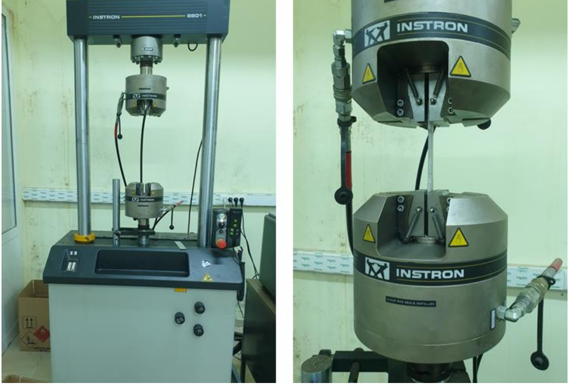
Şekil 4.11. Çekme deneyi makinesi ve çeneler içine yerleştirilmiş deney numunesi
