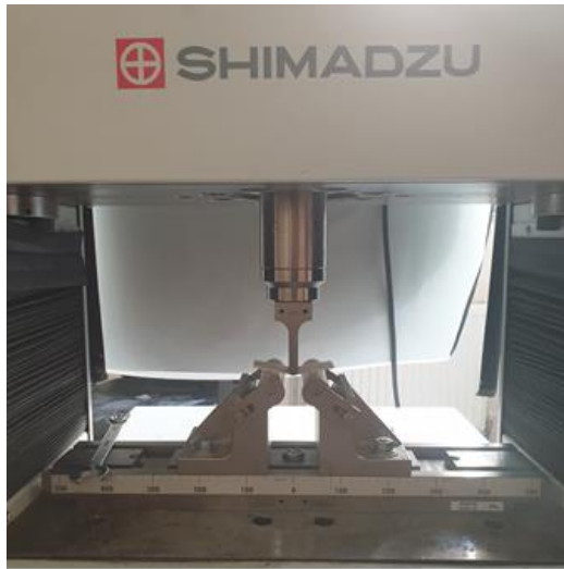
Şekil 4.22. Eğme test cihazında makineye yerleştirilmiş test numunesi
