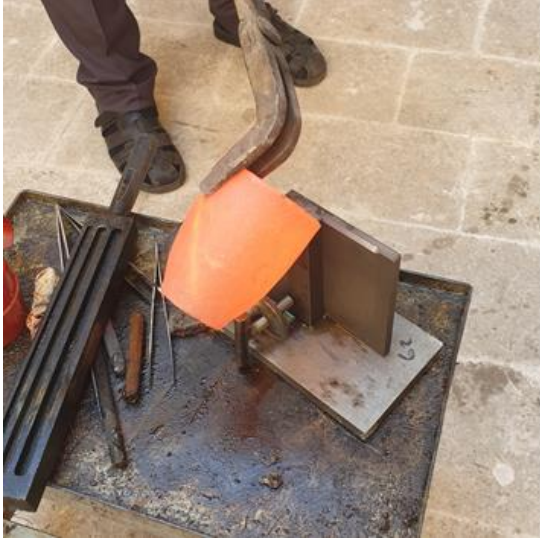
Şekil 4.5. Eritilmiş alaşımın astar kalıba dökülmesi ve kalıptan alaşım çubuğun çıkarılması
