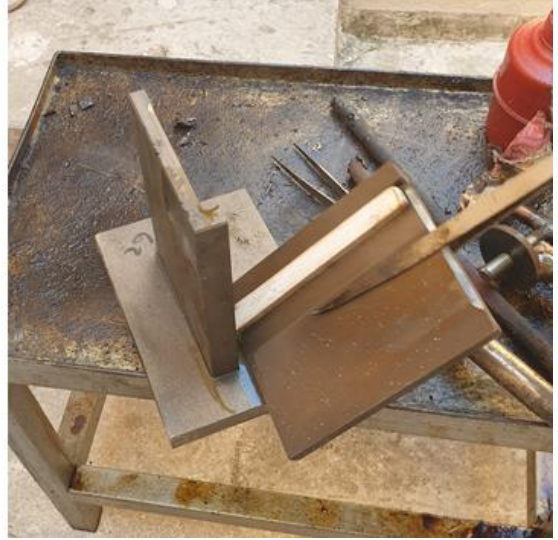
Şekil 4.5. Eritilmiş alaşımın astar kalıba dökülmesi ve kalıptan alaşım çubuğun çıkarılması
