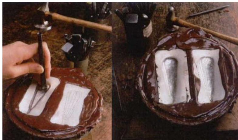
Şekil 3.19. Repousse tekniği uygulaması (Codina, 2000)
