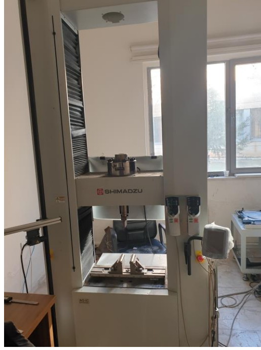
Şekil 4.21. Eğme deneyi makinesi ve mafsallar arasına yerleştirilmiş deney numunesi
