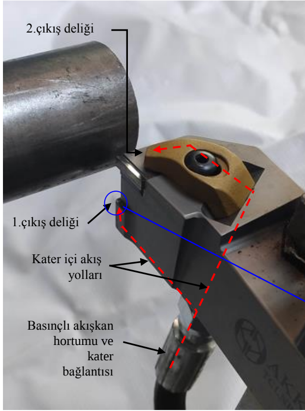
Dıştan Jetting ile soğutma sıvı akış yolları
