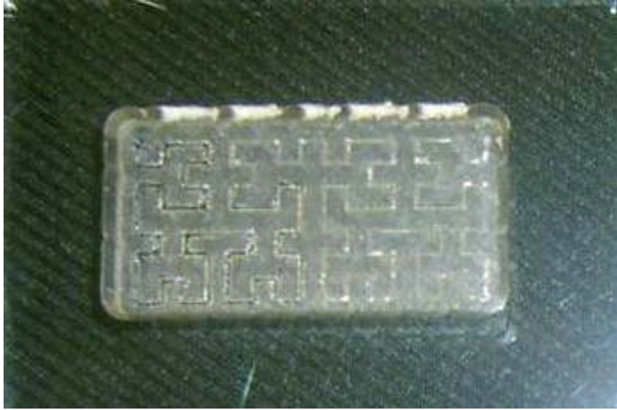
Şekil 5.3 Hilbert alan doldurma eğrisi ile işlenen akrilik parça
