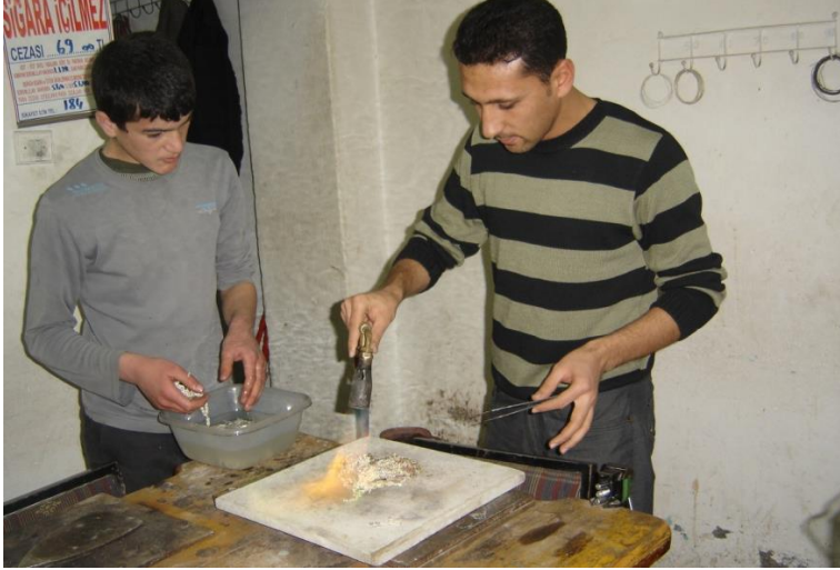
EK- 5. 20. Asit içinden çıkarılan ürünlerin üzerindeki boraks kalıntıların ateşle temizlenme işlemi
