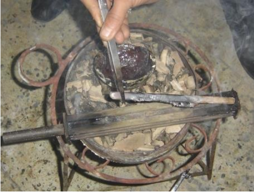
EK- 5. 12. Oluklu silindirden tel çekme işlemi
