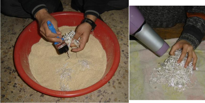
EK- 5. 22. Parlatma dolabı içinden çıkarılan ürünlerin talaş ile kurutulması ve talaş kalıntılarının temizlenme işlemi
