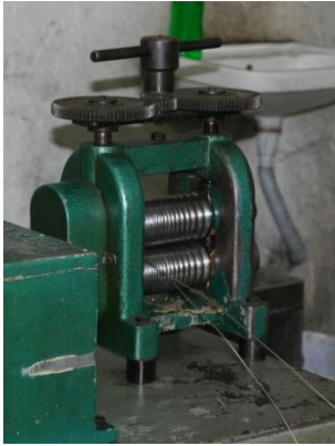
EK- 5. 12. Oluklu silindirden tel çekme işlemi
