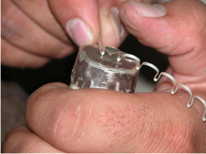
EK- 5. 14. Kalıp ile iskelet oluşturma
