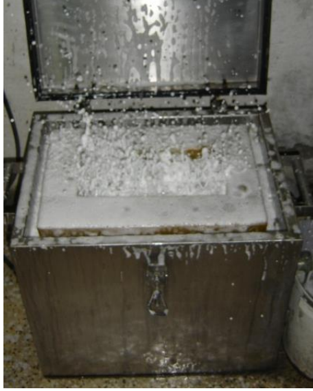
EK- 5. 21. Gümüş eserlerin parlatma dolabında yıkanması işlemi
