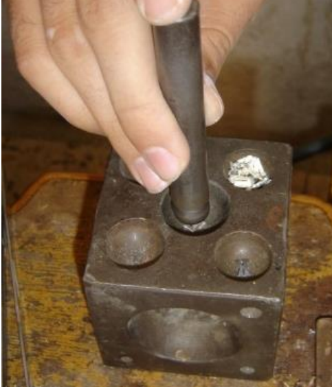
EK- 5. 17. Heşteek takımı ile süslemede kullanılacak büyük boyutlu küreler elde edilmesi
