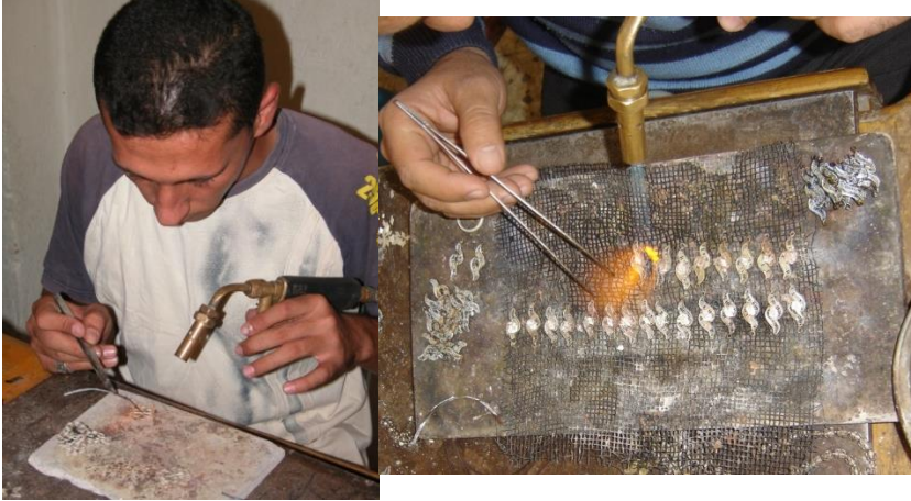
EK- 5. 18. Parçaları birleştirmek için kaynak işlemi
