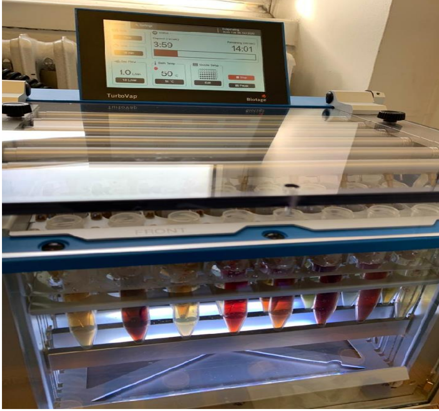
Resim 3.4. Azot jeneratörlü Turbovap cihazına yüklenmiş numuneler
