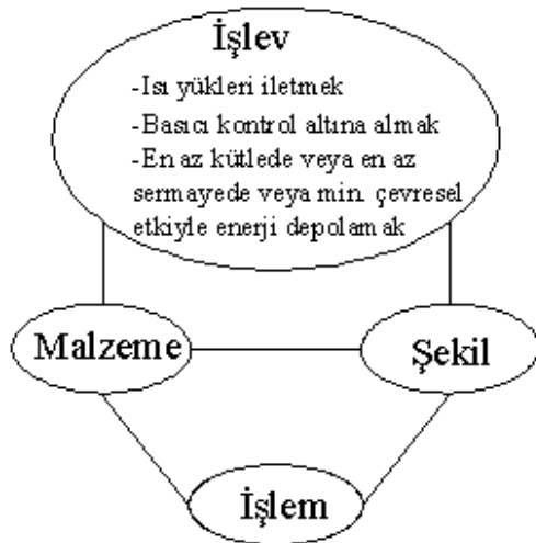
Şekil 3.4. Tasarımda malzeme seçiminin ana problemi: İşlev, malzeme, işlem ve şekil arasındaki etkileşim [17].
