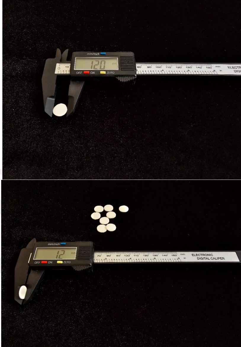
Şekil 3.10: Örneklerin Kalınlık Ve Çaplarının Dijital Kumpas İle Ölçülmesi
